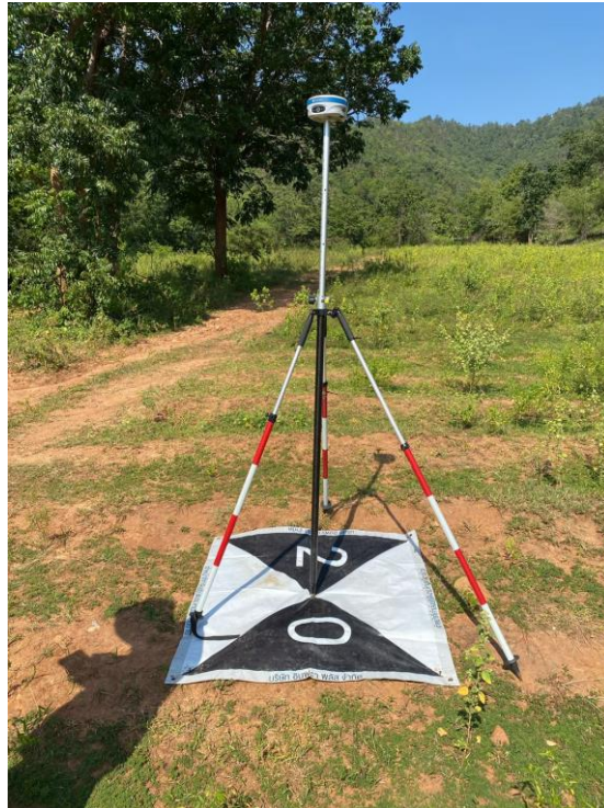
รูปที่ 3-21 การรังวัดค่าพิกัดจุดควบคุมภาพถ่ายด้วยเครื่องรับสัญญาณดาวเทียม GNSS
