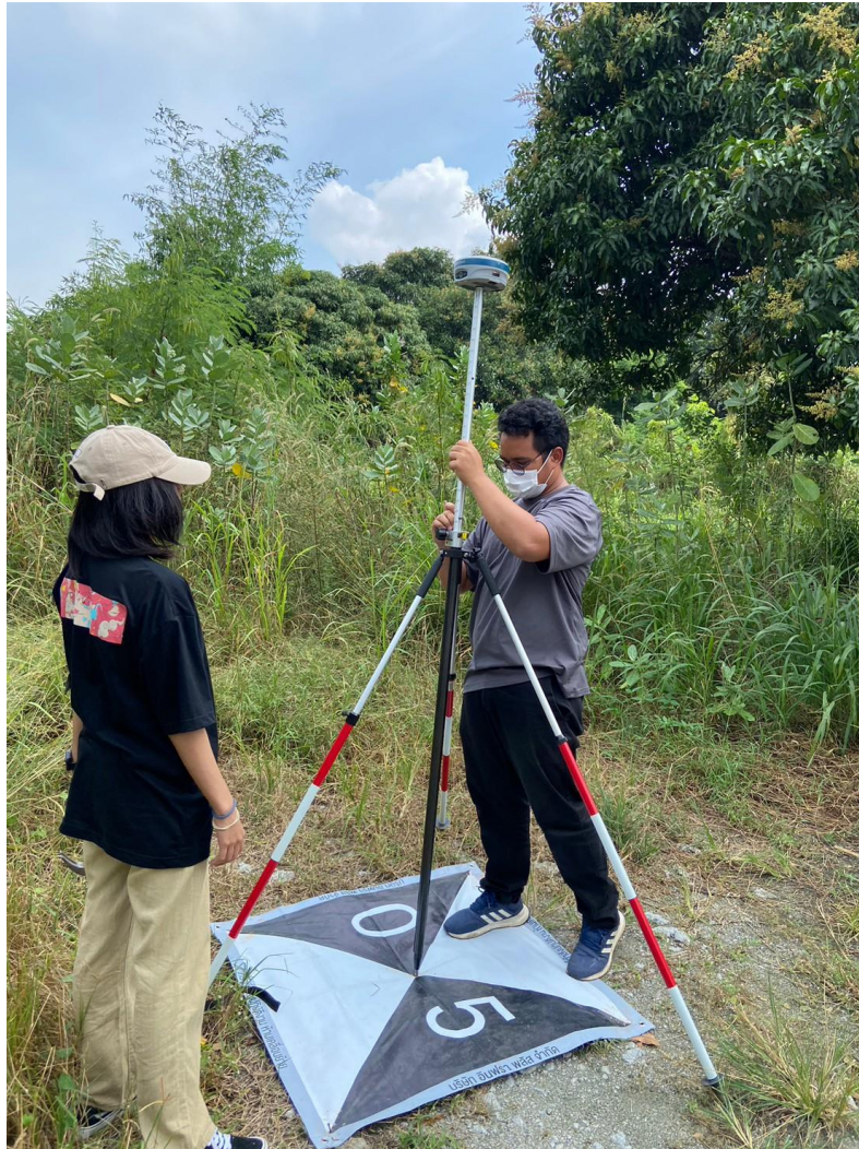
รูปที่ 3-28 การรังวัดค่าพิกัดจุดควบคุมภาพถ่ายด้วยเครื่องรับสัญญาณดาวเทียม GNSS
