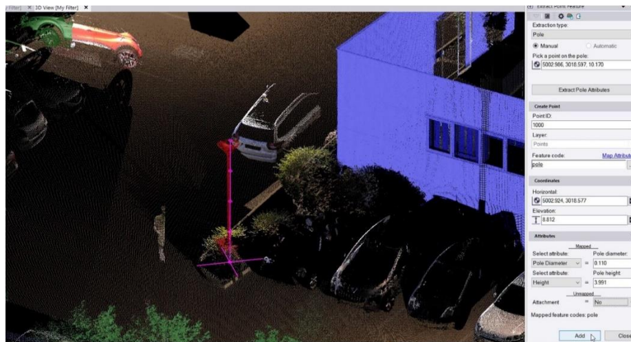
รูปที่ 2-10 ตัวอย่างข้อมูลแบบจุดพอยต์คลาวด์จากอุปกรณ์เลเซอร์วัดระยะแบบ 3D
