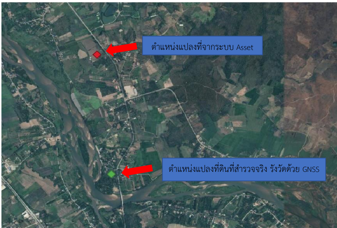
รูปที่ 2-68 เปรียบเทียบตำแหน่งแปลงดินในระบบบริหารทรัพย์สินนอกเขตทาง กับตำแหน่งที่รังวัดด้วย GNSS RTK
