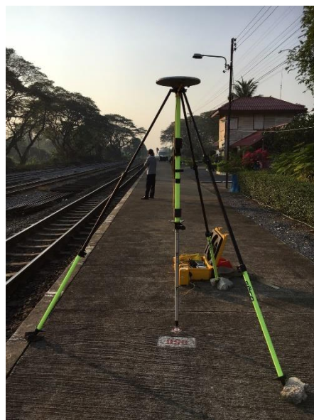
รูปที่ 2-16 ตัวอย่างภาพอุปกรณ์รับค่าพิกัดดาวเทียม GNSS
