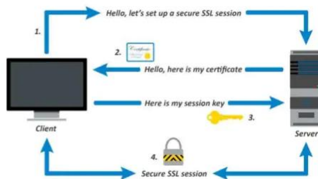
รูปที่ 2-93 การเพิ่มระดับความปลอดภัยโดยใช้ Secure Socket Layer (SSL)
