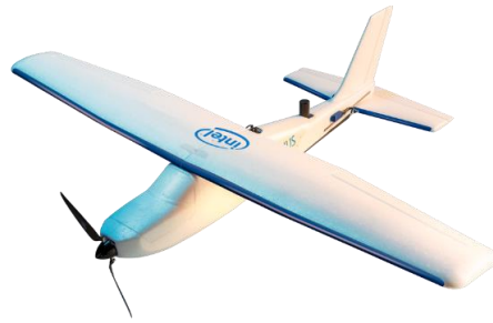
รูปที่ 2-11 ตัวอย่างอากาศยานไร้คนขับชนิดปีกตรึง (Fixed Wing)
