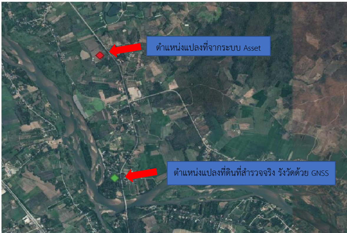
รูปที่ 2-47 เปรียบเทียบตำแหน่งแปลงดินในระบบบริหารทรัพย์สินนอกเขตทาง กับตำแหน่งที่รังวัดด้วย GNSS RTK
