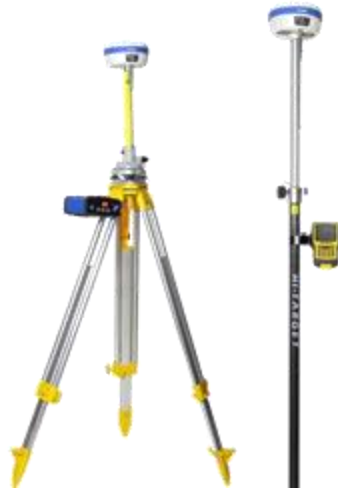
รูปที่ 2-34 เครื่องมือที่ใช้ในการสำรวจแปลงที่ดินนอกเขตทาง
