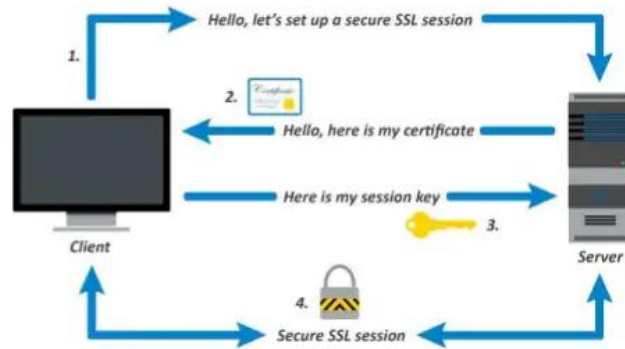
รูปที่ 2-102 การเพิ่มระดับความปลอดภัยโดยใช้ Secure Socket Layer (SSL)
