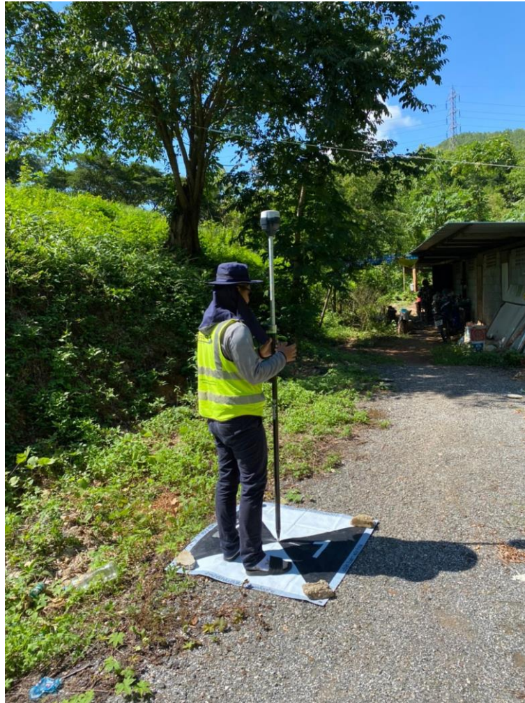
รูปที่ 3-19 การรังวัดค่าพิกัดจุดควบคุมภาพถ่ายด้วยเครื่องรับสัญญาณดาวเทียม GNSS
