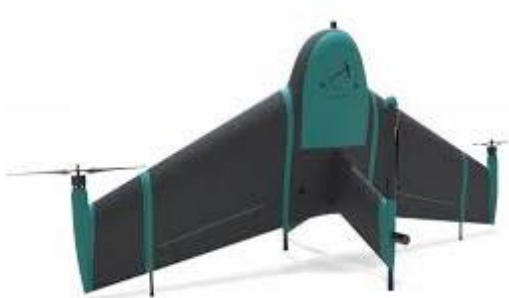
รูปที่ 2-13 ตัวอย่างอากาศยานไร้คนขับชนิดปีกตรึงขึ้นลงแนวดิ่ง (Fixed-Wing Hybrid)
