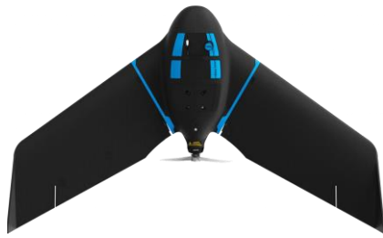
รูปที่ 2-11 ตัวอย่างอากาศยานไร้คนขับชนิดปีกตรึง (Fixed Wing)
