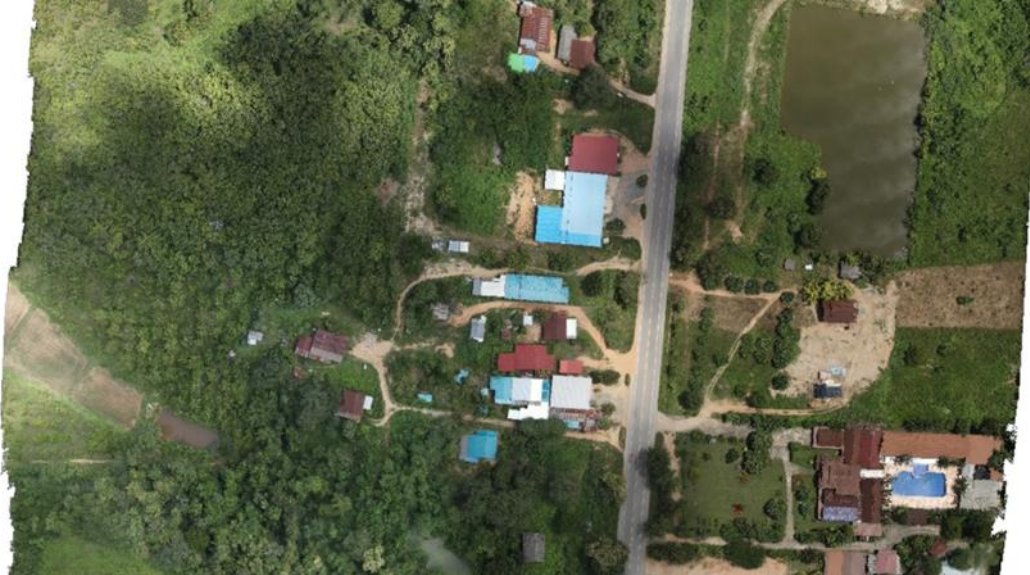
รูปที่ 3-25 ภาพออร์โธโมเสค (Orth mosaic)
