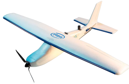
รูปที่ 2-11 ตัวอย่างอากาศยานไร้คนขับชนิดปีกตรึง (Fixed Wing)
