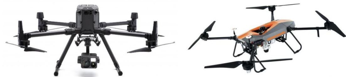
รูปที่ 2-32 ตัวอย่างอากาศยานไร้คนขับชนิดปีกหมุน (Multirotor)
