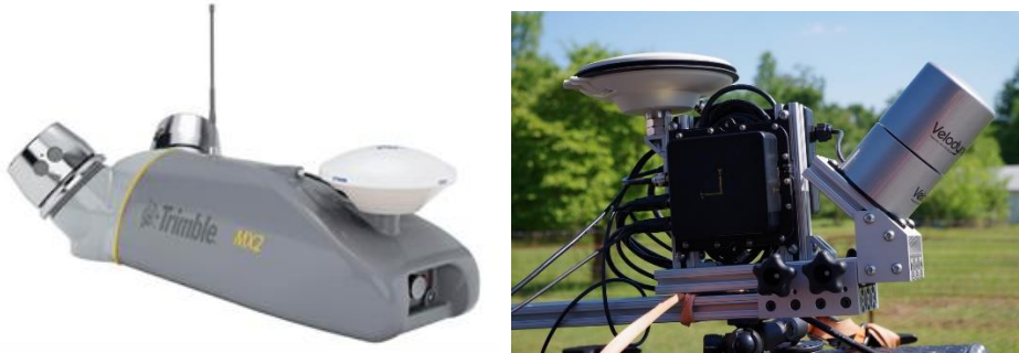
รูปที่ 2-29 ตัวอย่างอุปกรณ์เลเซอร์วัดระยะแบบ 3D
