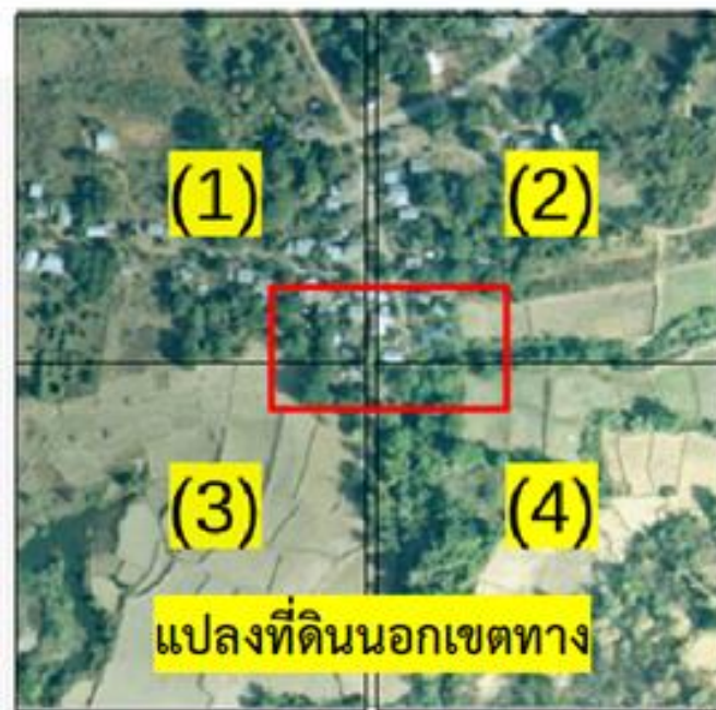
รูปที่ 2-68 แสดงตัวอย่างการซ้อนทับข้อมูลรูปแปลงที่ดินกับระวางภาพถ่ายทางอากาศ
