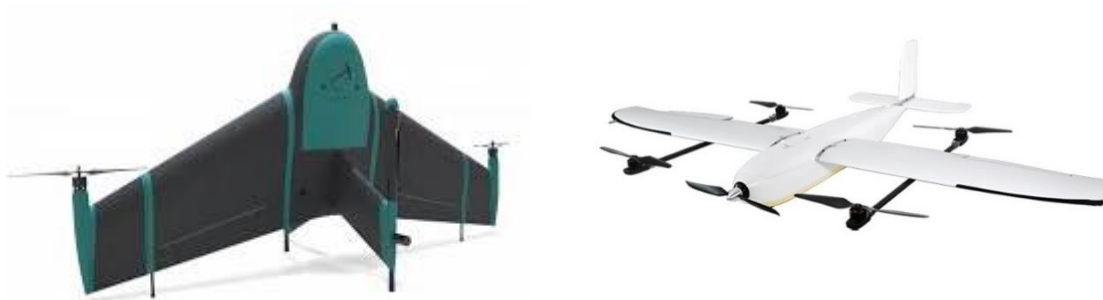
รูปที่ 2-33 ตัวอย่างอากาศยานไร้คนขับชนิดปีกตรึงขึ้นลงแนวดิ่ง (Fixed-Wing Hybrid)
