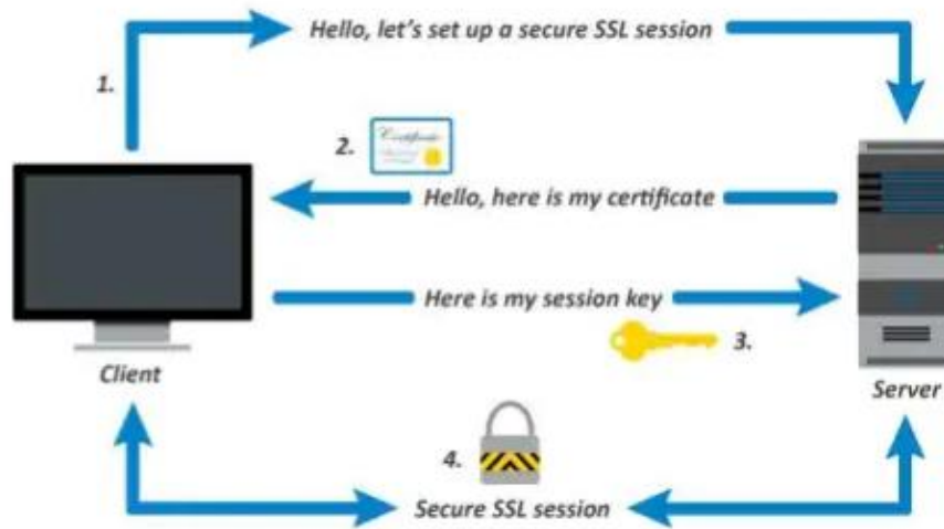
รูปที่ 2-103 การเพิ่มระดับความปลอดภัยโดยใช้ Secure Socket Layer (SSL)
