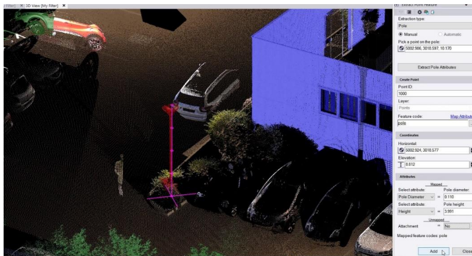
รูปที่ 2-30 ตัวอย่างข้อมูลแบบจุดพอยต์คลาวด์จากอุปกรณ์เลเซอร์วัดระยะแบบ 3D
