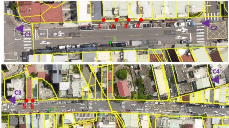
รูปที่ 2-35 ตัวอย่างผลลัพธ์จากการบินสำรวจเพื่อทำแผนที่โดยอากาศยานไร้คนขับ
