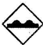
แผ่นคอนกรีตอาจทรุดเป็นแอ่งในบริเวณที่คันทางทruzด้วยสาเหตุที่ไม่ทราบชัดเจน สาเหตุของการชำรุดอาจเกิดจากภาระอัดตัวภายใน (consolidation) ของตินฐานราก หรือเกิดจากการก่อสร้างไม่เรียบเรียวย เช่นบริเวณที่วางห้อผลัดคันทาง เนื่องจากการบดอัดวัสดุ บริเวณที่วางห้อกพร่อง การชำรุดชนิดนี้ทำให้เกิดน้ำขังเป็นอันตรายต่อโครงสร้างทางและผู้ใช้งานใช้ถนน
