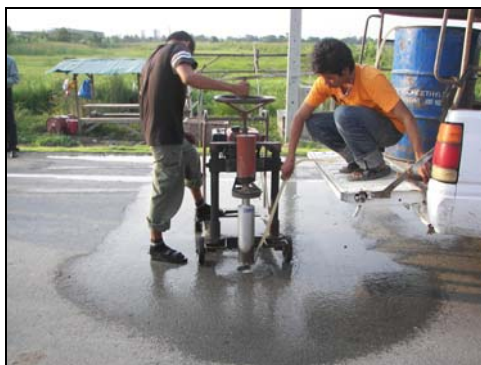
เครื่องเจาะก้นตัวอย่าง (Core - drilling Machine) ในสนาม
