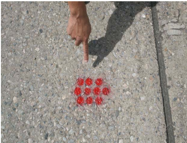
รูปที่ 2.12 ทดสอบกำลังอัดของคอนกรีต โดยใช้เครื่องทดสอบ Rebound Hammer
