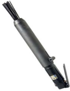
รูปที่ 7.9 แสดงเครื่องมือ Needle Scaler (Emmons, 1993)
