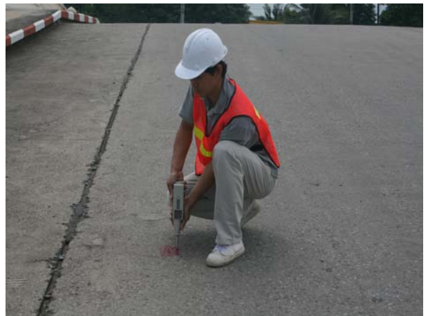
รูปที่ 2.12 ทดสอบกำลังอัดของคอนกรีต โดยใช้เครื่องทดสอบ Rebound Hammer
