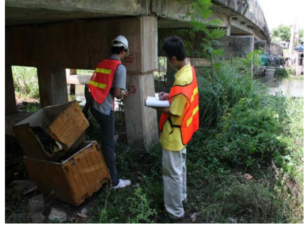
รูปที่ 2.14 ทดสอบกำลังรับแรงอัดของคอนกรีตด้วย Rebound hammer
