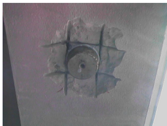
รูปที่ 8.8 การทดสอบ Pull-off Test
