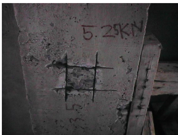
รูปที่ 8.8 การทดสอบ Pull-off Test
