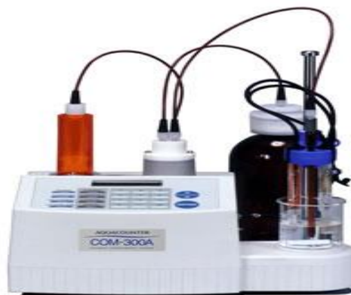
รูปที่ 5-39 อุปกรณ์ชุดทดสอบหาปริมาณคลอไรด์
