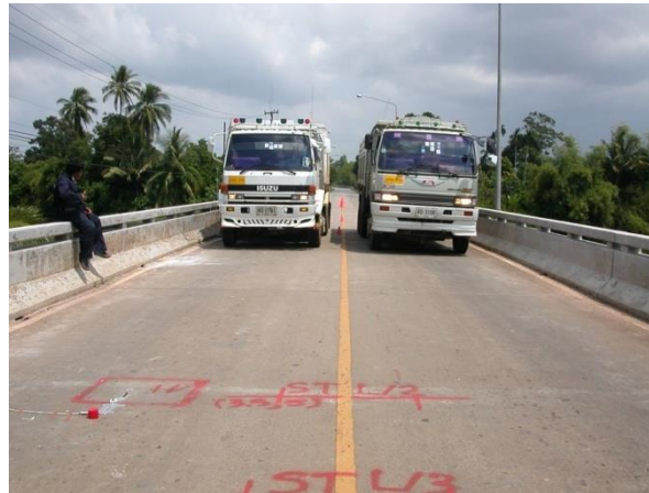
รูปที่ 5-40 การทดสอบการรับน้ำหนักบรรทุกทุกจริง
