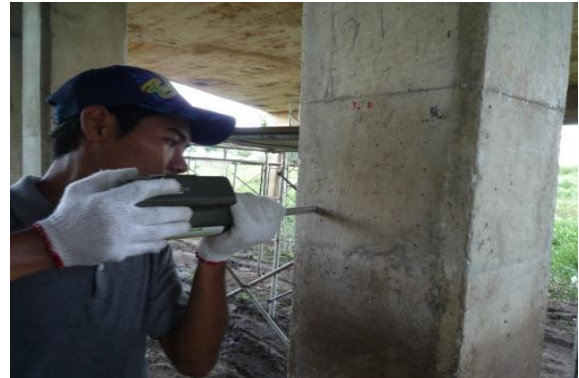
รูปที่ 5-36 เครื่อง Rebound Hammer และวิธีการทดสอบด้วยวิธี Compressive Strength
