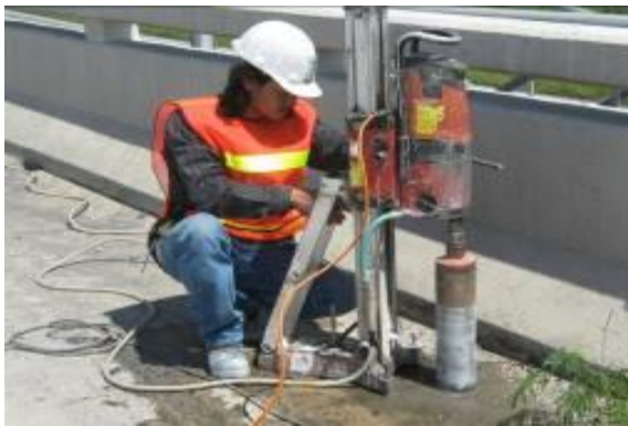
รูปที่ 5-34 เครื่องเจาะเก็บแท่งตัวอย่างคอนกรีต(Coring) และก้อนคอนกรีตตัวอย่าง
