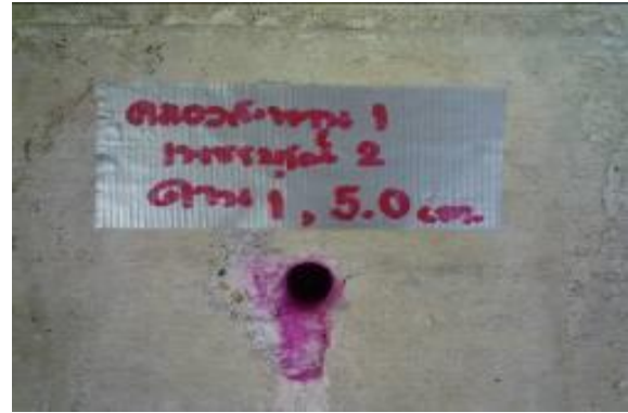
รูปที่ 5-38 วิธีการทดสอบด้วยวิธี การเกิดปฏิกิริยาคาร์บอนเนชั่น
