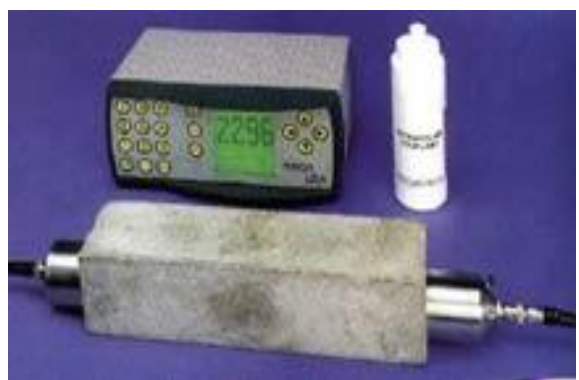
รูปที่ 5-37 วิธีการทดสอบด้วยวิธี Ultrasonic pulse – velocity Method
