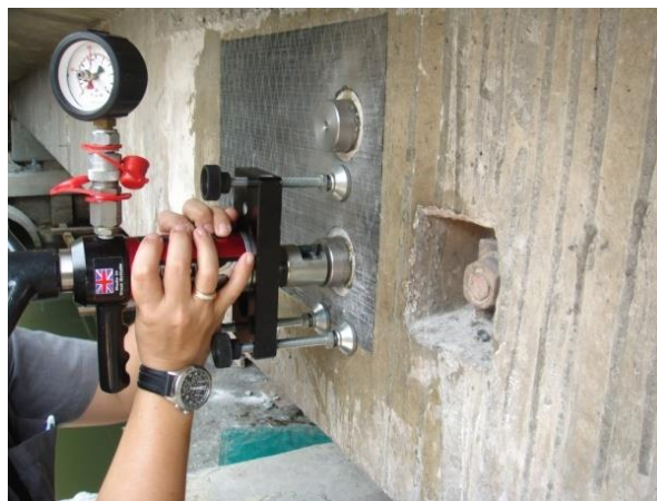
รูปที่ 5-35 การทดสอบด้วยวิธี Pullout Test
