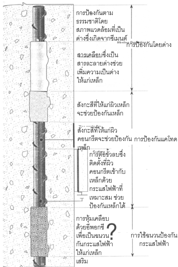
รูปที่ 5-15 แสดงถึงการสรุปวิธีการป้องกันแก่เหล็กเสริมในคอนกรีต
