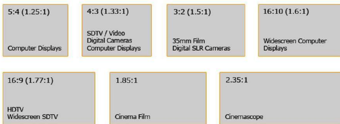
รูปที่ 3-4 แสดงตัวอย่างสัดส่วนของภาพถ่าย 43
