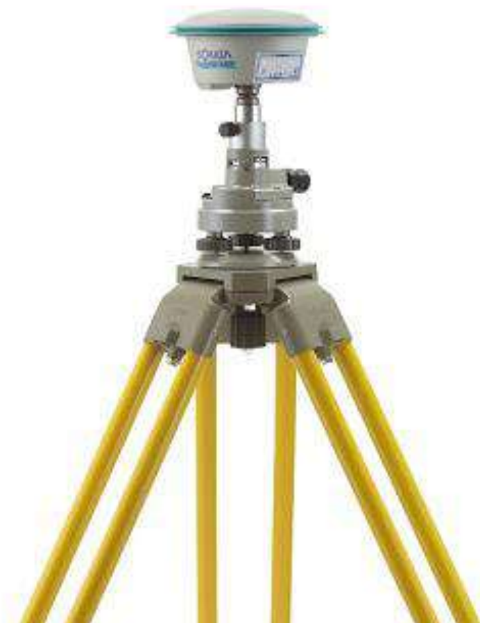
รูปที่ 2-3 เครื่องรับสัญญาณ GNSS แบบความถี่เดียว (Single Frequency Receiver) 36
