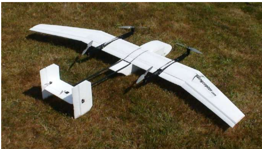
รูปที่ 1-26 อากาศยานไร้คนขับชนิดปีกตรึงขึ้นลงแนวดิ่ง (Fixed-Wing Hybrid) 34
