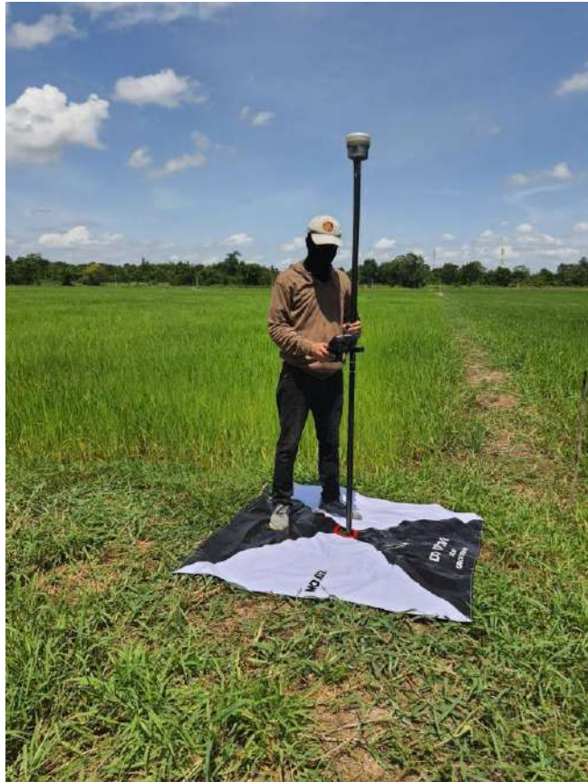
รูปที่ 6-1(ข) เครื่องรังวัดพิกัดด้วยการรังวัดด้วยระบบดาวเทียมนำหนพิภพ (GNSS)
