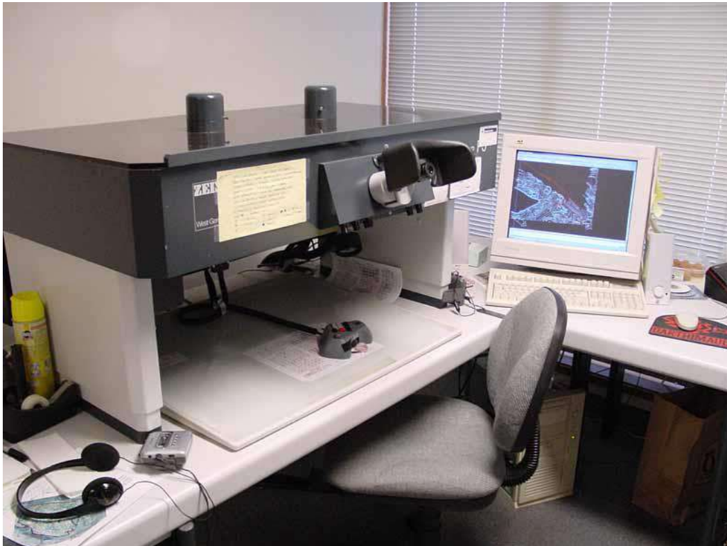
รูปที่ 1-13 เครื่อง Ziess Planicom P3 ซึ่งเป็นเครื่อง Stereo Plotter ในยุค Analytical Photogrammetry 22
