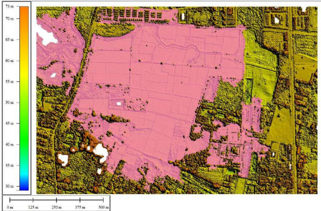
รูปที่ 6-9 ตัวอย่างการใช้ DEM จำลองพื้นที่น้ำท่วมเขตพื้นที่จัดรูปนครสวรรค์
