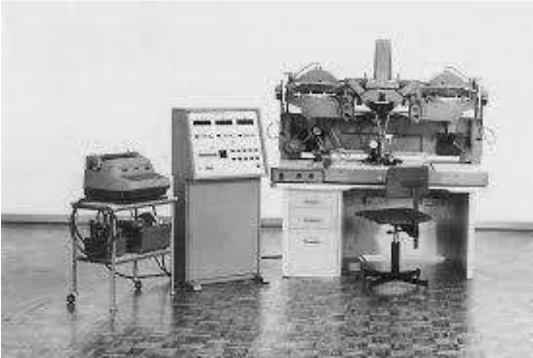
รูปที่ 1-10 เครื่อง Stereo Comparator ในยุค Analogue Photogrammetry 19
