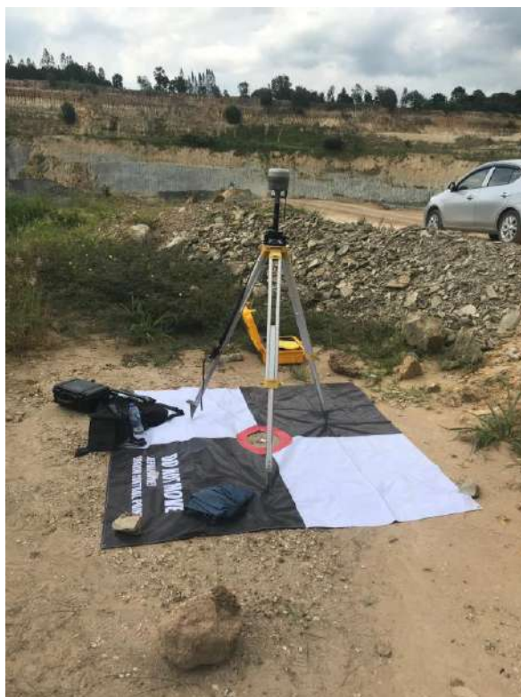
รูปที่ 2-5 การรังวัดแบบสถิต (Static Survey)
