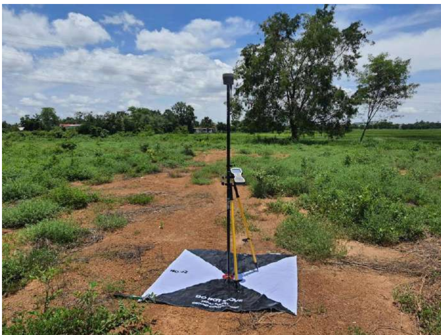
รูปที่ 2-6 การรังวัดแบบจลน์ (Kinematic Survey)
