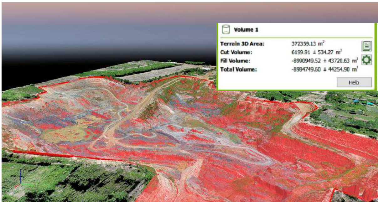
รูปที่ 6-11 ตัวอย่างการหาปริมาตรของงานดินขุดดินถม
