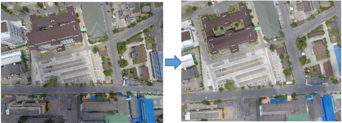
รูปที่ 5-2 ภาพตัวอย่างเปรียบเทียบ Orthophoto กับ True Orthophoto
