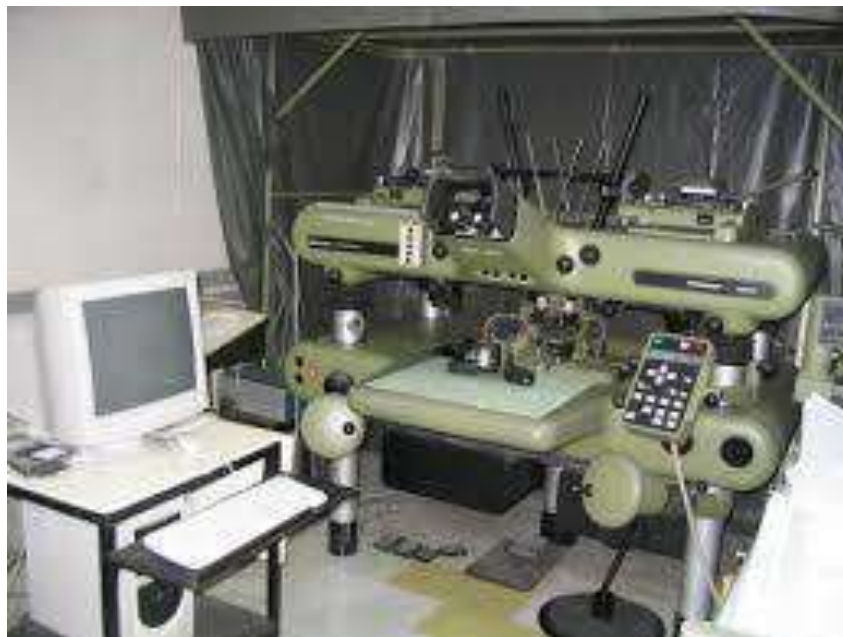
รูปที่ 1-14 เครื่อง Stereo Plotter ในยุค Digital Photogrammetry 23
