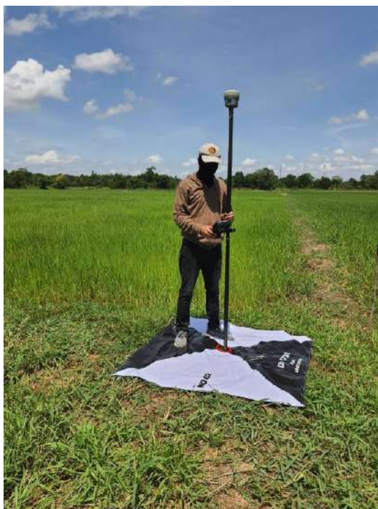
รูปที่ 2-7 การรังวัดแบบจลน์ทันทีทันใด (Real-time Kinematic Survey: RTK)
