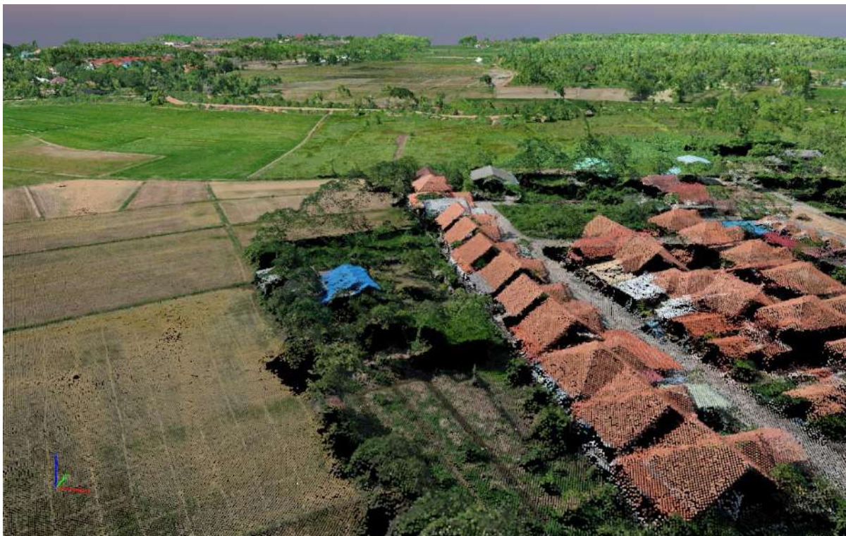
รูปที่ 1-18 ตัวอย่างกลุ่มจุดพิกัดสามมิติ (Point Cloud)
