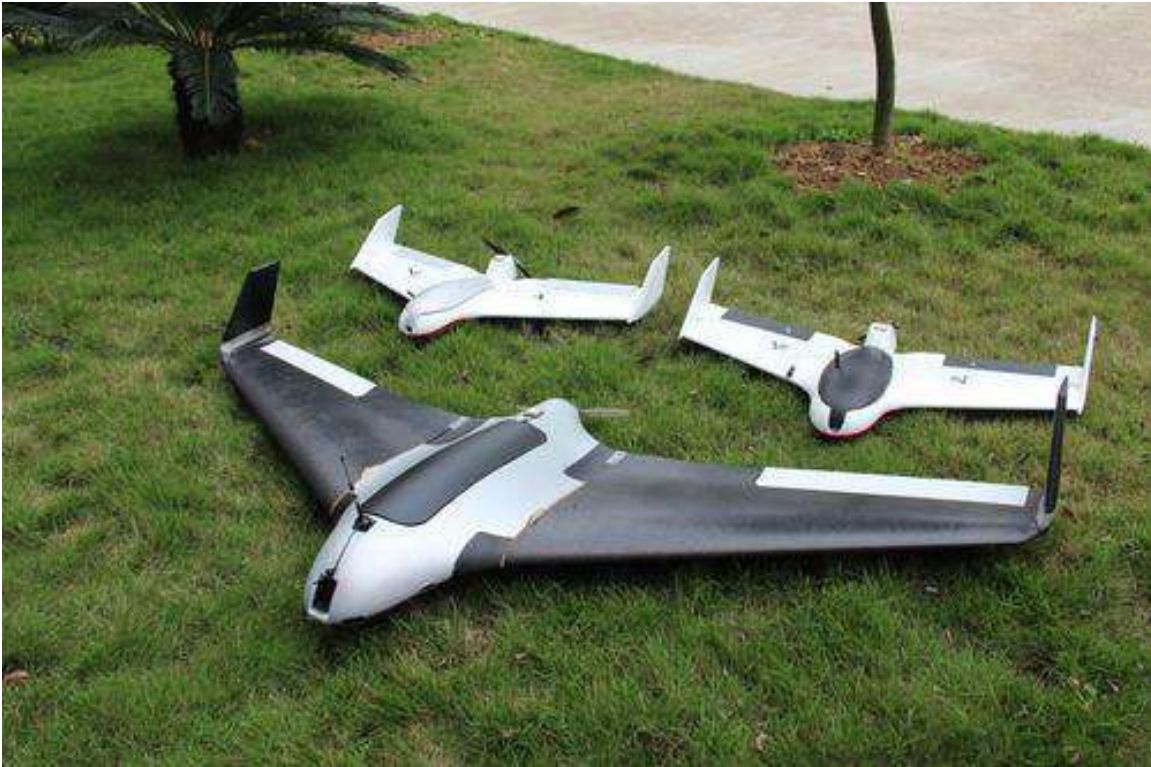
รูปที่ 1-23 อากาศยานไร้คนขับชนิดปีกตรึง (Fixed Wing) 31
