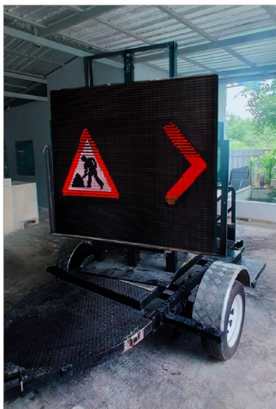
ที่มา คู่มือการใช้งานป้ายเปลี่ยนข้อความได้ชนิด FULL COLOUR สำหรับปฏิบัติการบนทางหลวงแบบมีล้อลากจูง รูปที่ 5.3-6 ลักษณะป้ายเปลี่ยนข้อความได้สำหรับการบริหารบนทางหลวงแบบมีล้อลากจูง (Mobile Variable Message Signs: MVMS)
