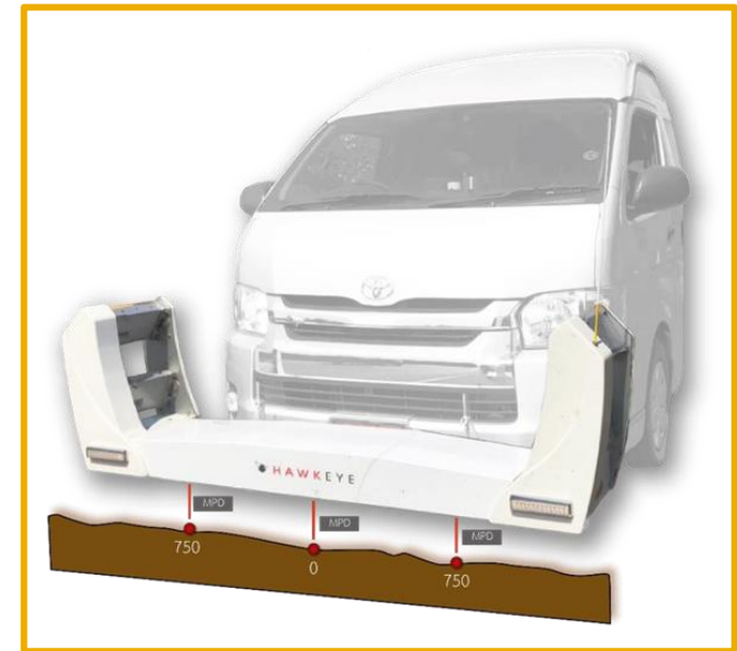
อุปกรณ์เลเซอร์ของรถสำรวจลักษณะที่ 1 ที่ใช้สำหรับเก็บค่า MPD
