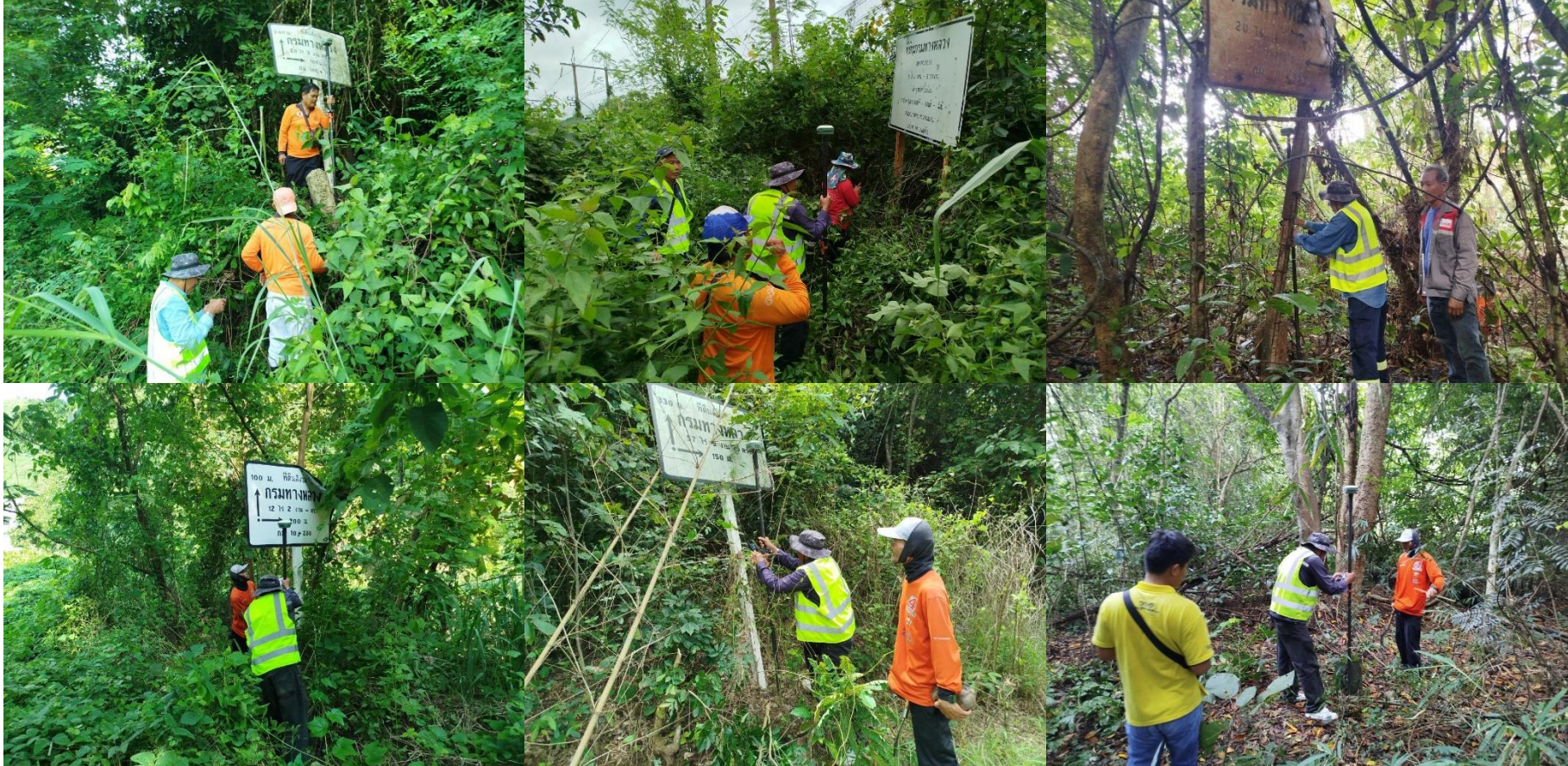
รูปที่ 2-2 การสำรวจจริงวัด และปรับปรุงแผนที่รูปแปลงที่ดินสงวนนอกเขตทาง โดยระบบโครงข่ายการรังวัดดาวเทียมแบบจลน์ (RTK GNSS Network)
