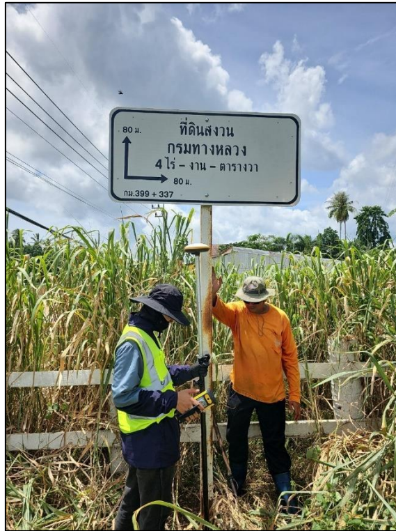
รูปที่ 3-6 การรังวัดด้วยดาวเทียม (RTK)
