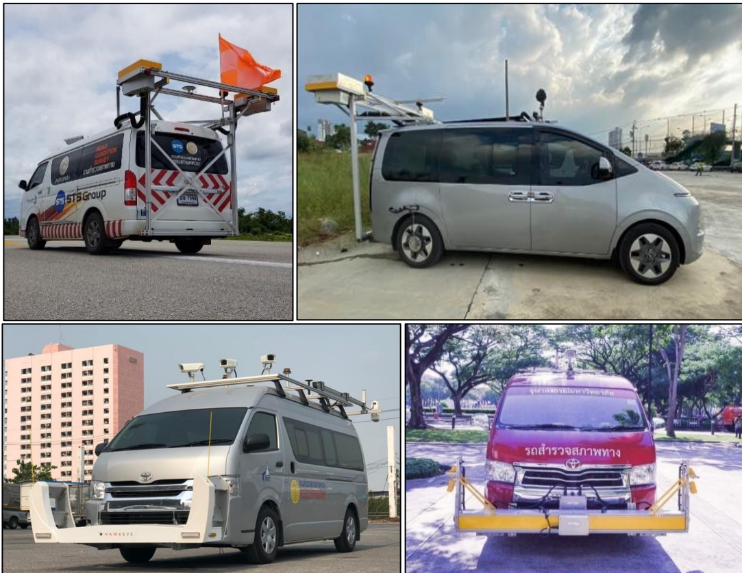
รูปที่ 2 รถสำรวจพร้อมอุปกรณ์สำรวจสภาพทางและกล้องถ่ายภาพแยกตามประเภทอุปกรณ์
