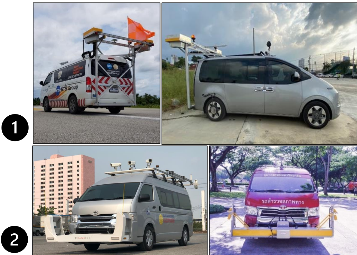
รูปที่ 2 รถสำรวจพร้อมอุปกรณ์สำรวจสภาพทางและกล้องถ่ายภาพแยกตามประเภทอุปกรณ์
