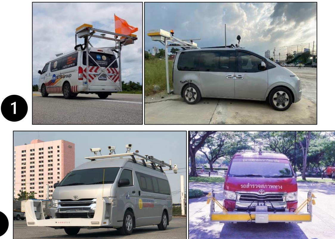
รูปที่ 2 รถสำรวจพร้อมอุปกรณ์สำรวจสภาพทางและกล้องถ่ายภาพ
