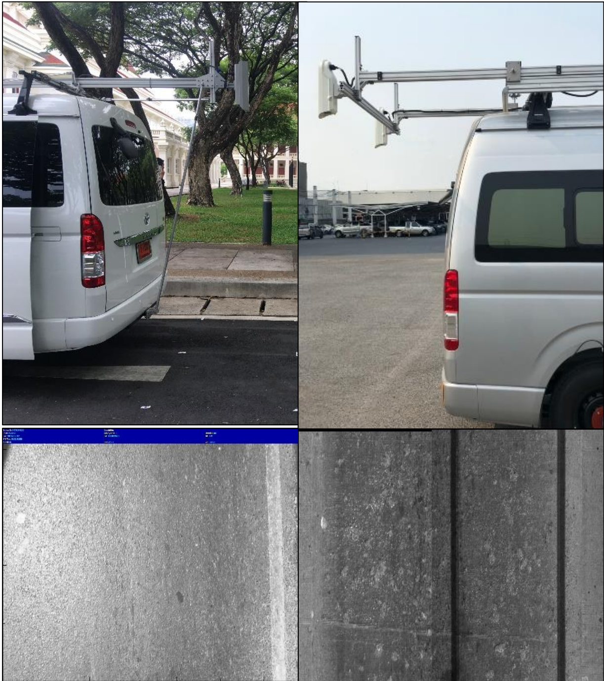
รูปที่ 3-20 กล้องบันทึกภาพผิวทาง และตัวอย่างภาพจากกล้องบันทึกภาพผิวทาง
