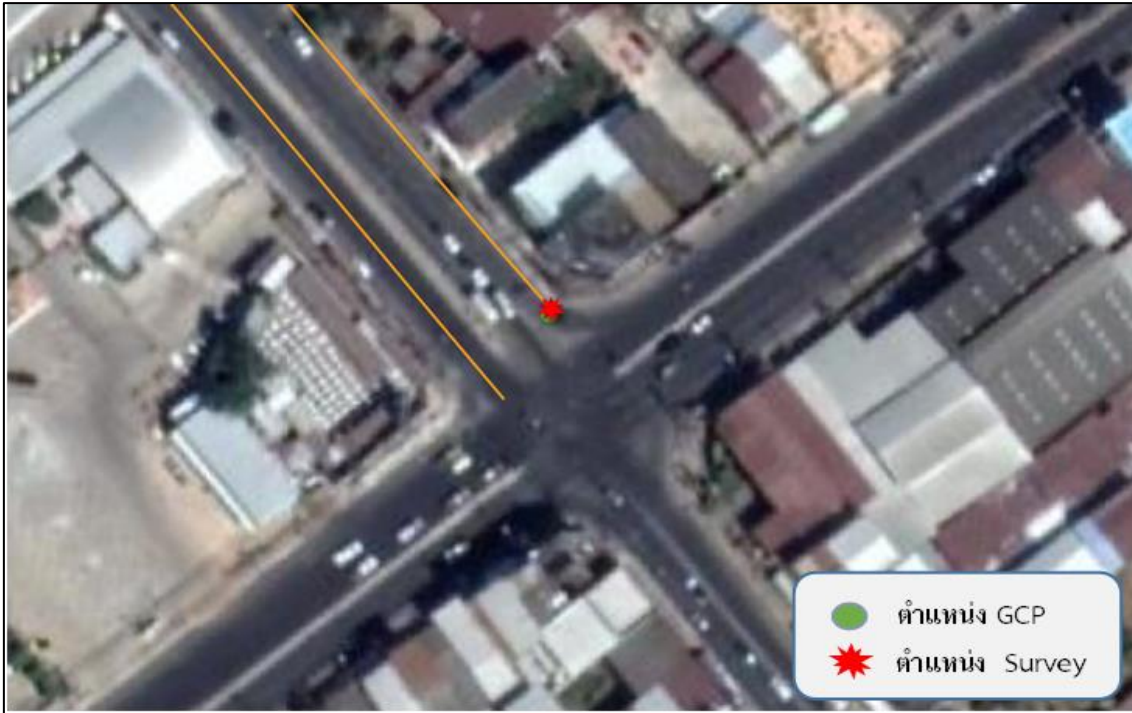
รูปที่ 2-103 แสดงตัวอย่างจุด GCP และจุดที่ทำการตรวจสอบ ตำแหน่งที่ 1
