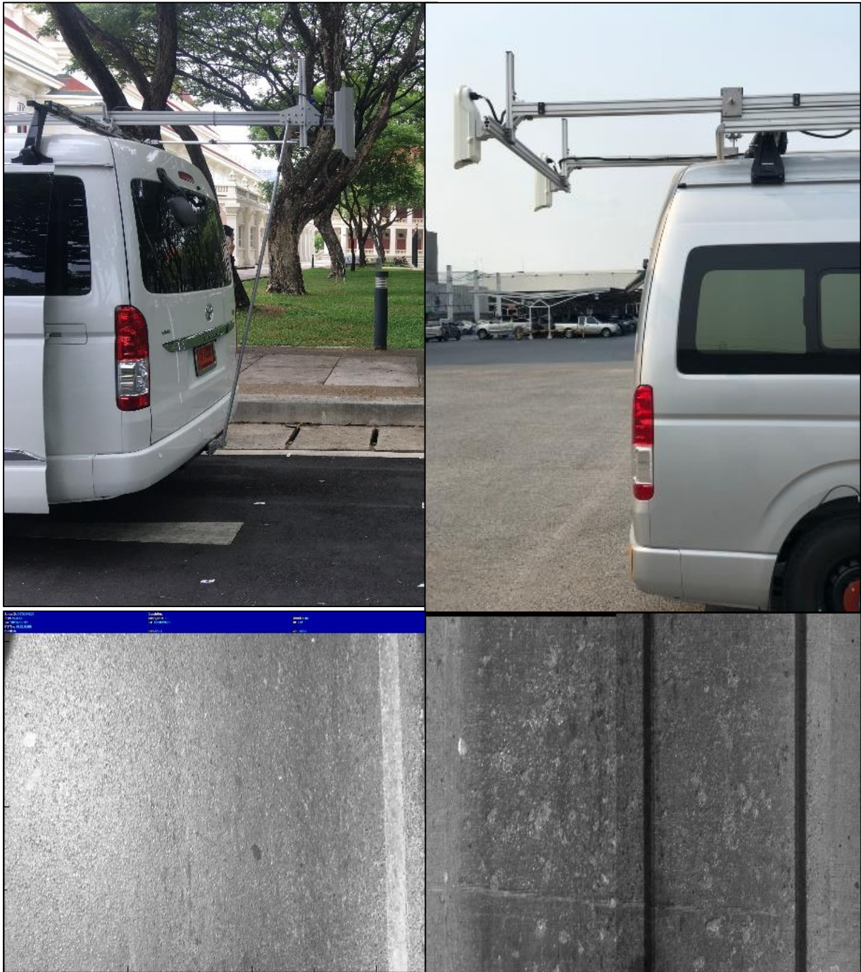
รูปที่ 2-20 กล้องบันทึกภาพผิวทาง และตัวอย่างภาพจากกล้องบันทึกภาพผิวทาง
