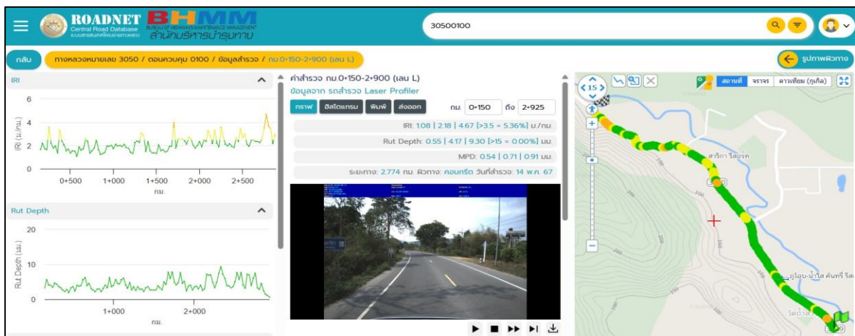
รูปที่ 2-60 แสดงผลการนำเข้าข้อมูลผิวลาดยาง สายทาง 3050 ตอนควบคุม 0100 อุปกรณ์รถสำรวจ LCMS และรถสำรวจด้วย Laser Profile
