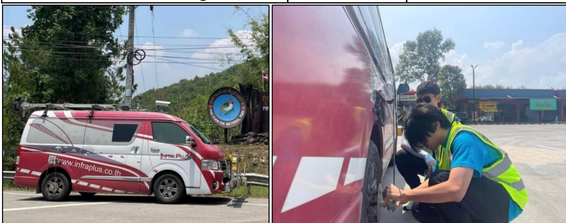
รูปที่ 2-63 การ Calibrate อุปกรณ์สำรวจ Laser Profiler คันที่ 1
