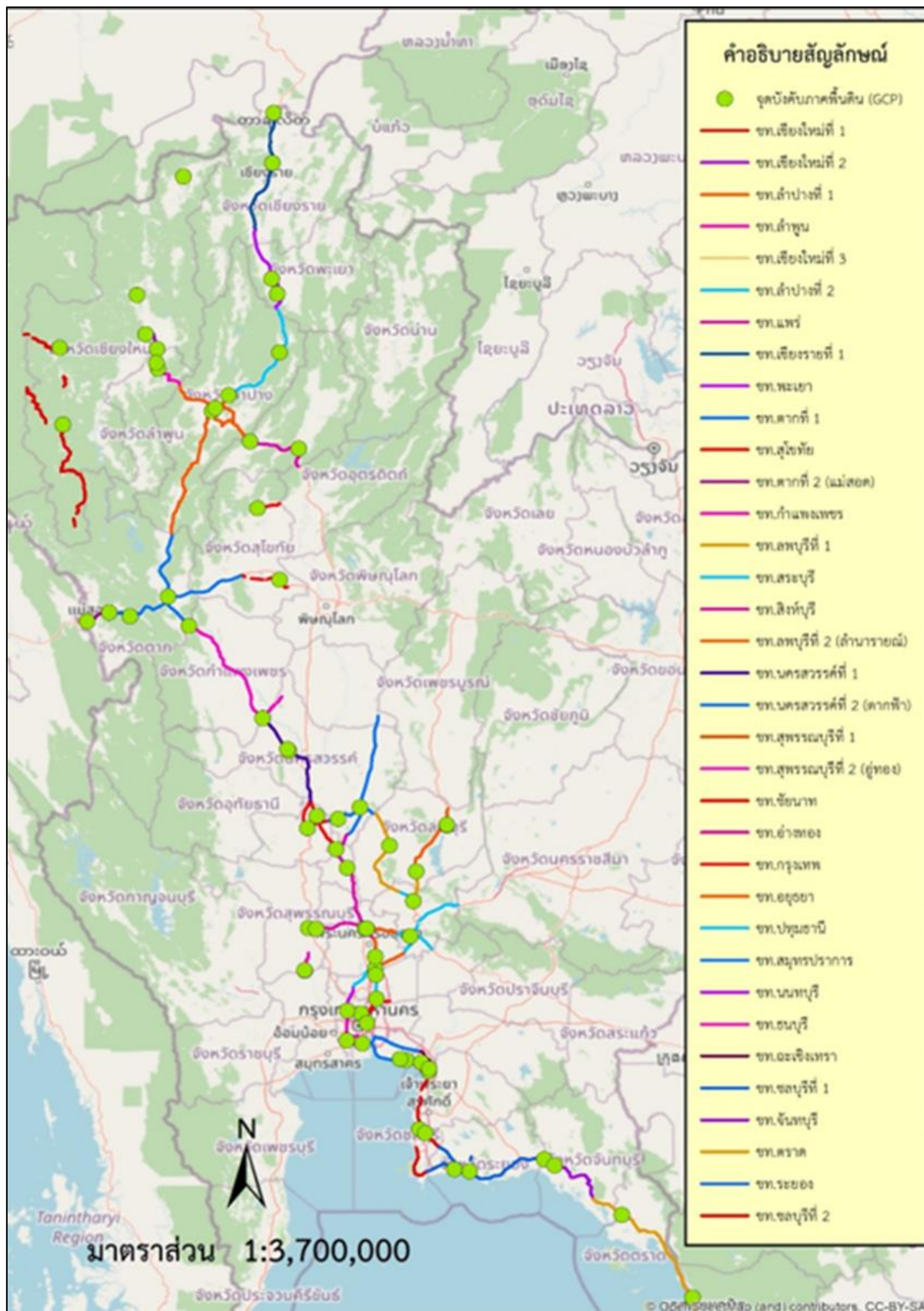
รูปที่ 2-102 แสดงตัวอย่างจุดบังคับภาคพื้นดิน GCP
