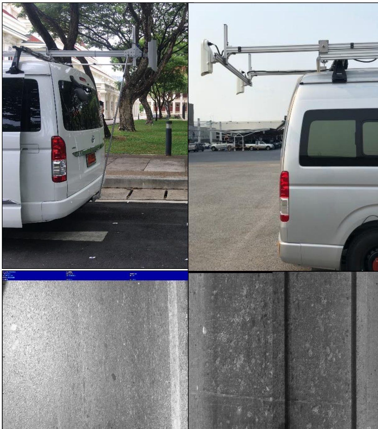
รูปที่ 2-20 กล้องบันทึกภาพผิวทาง และตัวอย่างภาพจากกล้องบันทึกภาพผิวทาง
