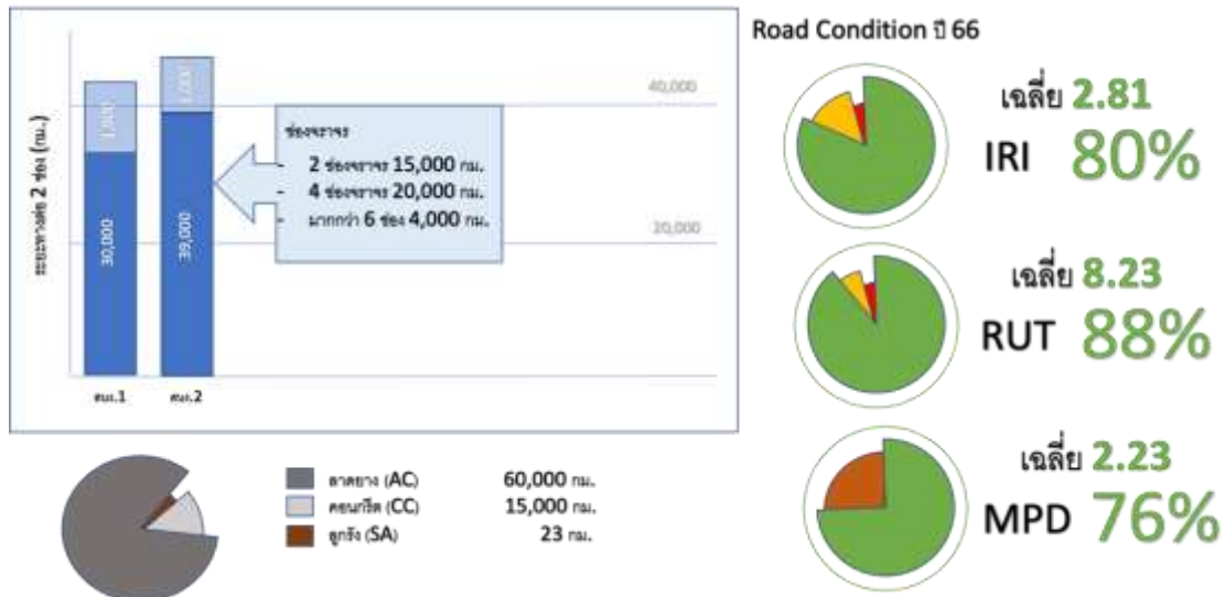
รูปที่ 2-68 ตัวอย่างการแสดงผลภาพรวมสรุปข้อมูล ข้อมูลสรุประยะทาง / ระยะทางต่อ 2 ช่อง >> ข้อมูลสรุปข้อมูลบัญชีผิวทาง >> ข้อมูลสรุปค่าสภาพทาง (1)
