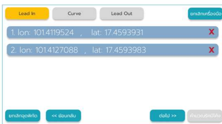
รูปที่ 2-152 ตัวอย่างการกำหนดตำแหน่งของเส้นทางก่อนเข้าโค้ง (Lead_In)
