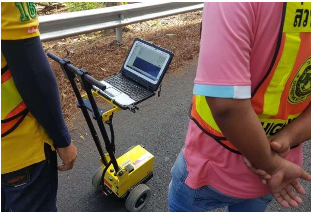
รูปที่ 2-177 เครื่องมือวัดความเรียบของผิวทางชนิดรถเข็น (SSI Walking Profiler)
