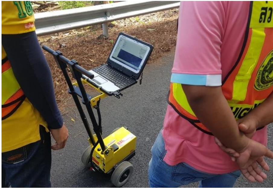
รูปที่ 4-117 เครื่องมือวัดความเรียบของผิวทางชนิดรถเข็น (SSI Walking Profiler)
