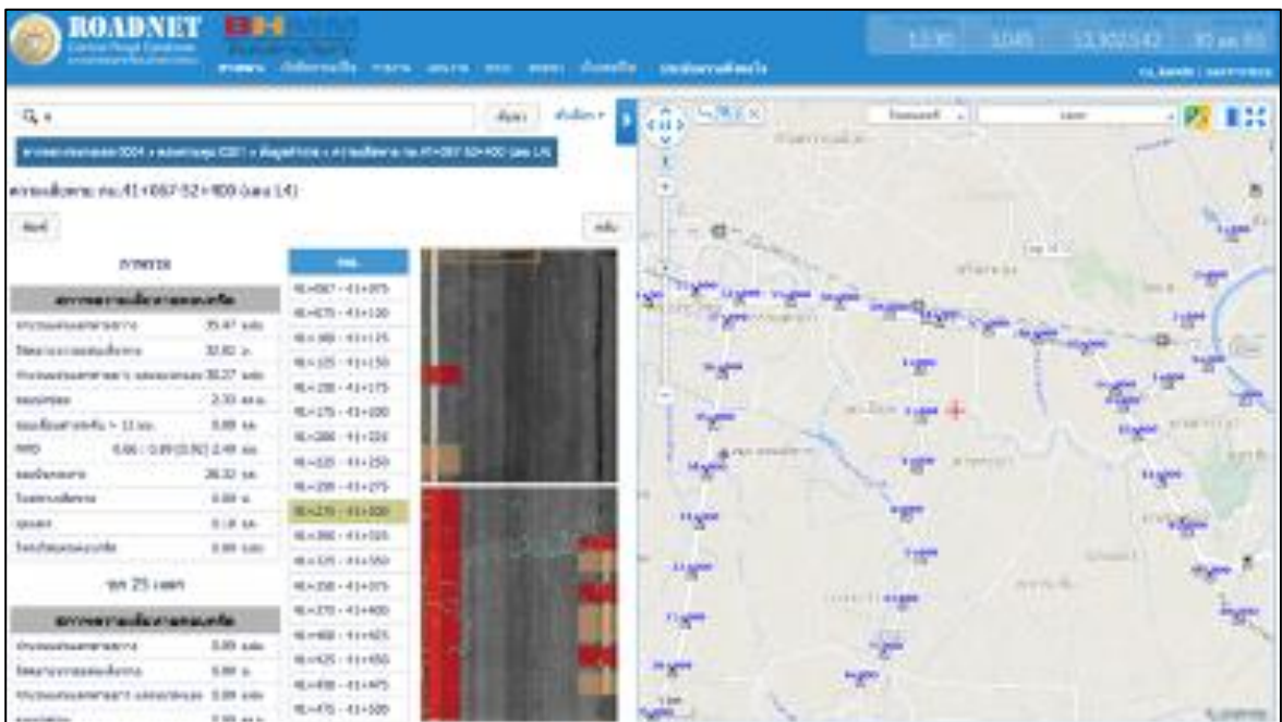
รูปที่ 4-12 แสดงผลข้อมูลภาพสำรวจภาพผิวทาง จากกล้องด้านหลังรถ
