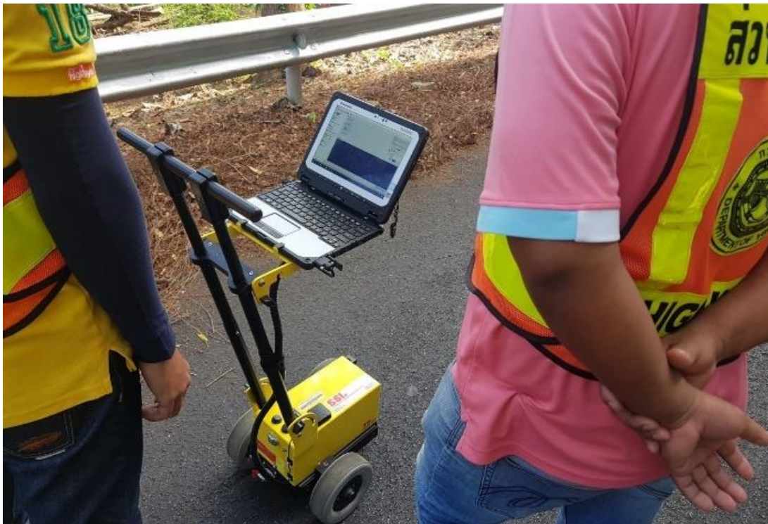
รูปที่ 2-189 เครื่องมือวัดความเรียบของผิวทางชนิดรถเข็น (SSI Walking Profiler)
