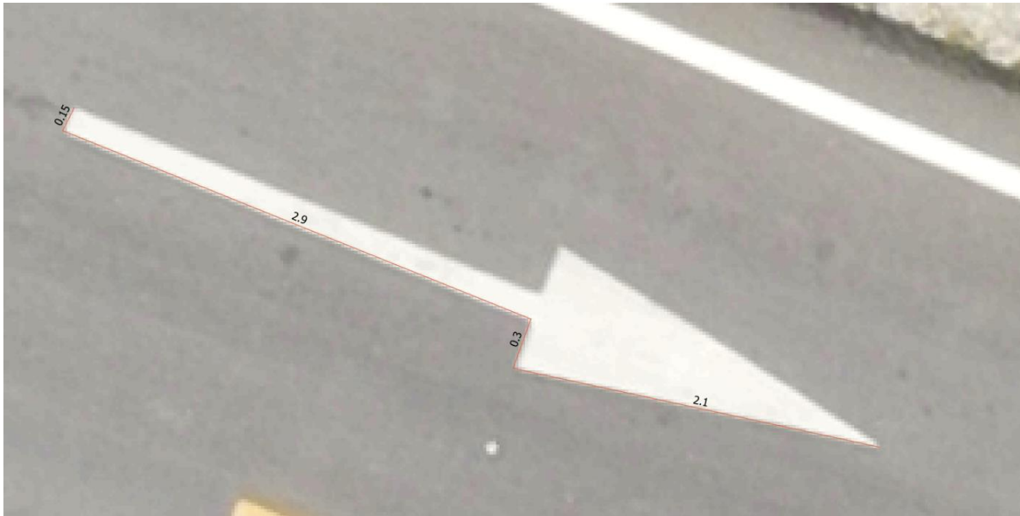
การวัดขนาดทรัพย์สิน ด้วยข้อมูลภาพ Ortho Photo
