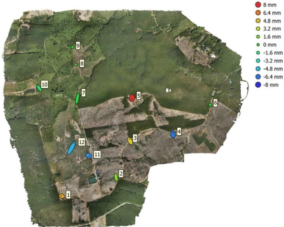
รูปที่ 4-12 แสดงตำแหน่งจุดควบคุมภาพถ่าย โดยที่ สีของรูปทรงรี แสดงถึง ความคลาดเคลื่อนทางตั้ง (Z) และ รูปร่างของทรงรี แสดงถึง ความคลาดเคลื่อนทางราบ (X, Y)
