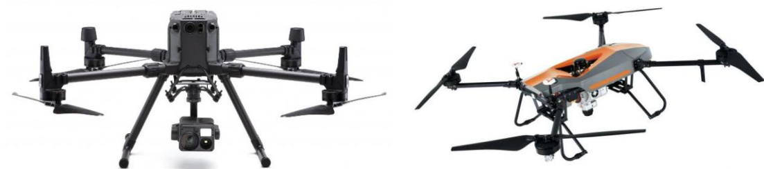
รูปที่ 2-41 ตัวอย่างอากาศยานไร้คนขับชนิดปีกหมุน (Multirotor)
