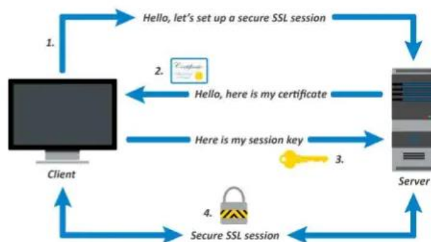
รูปที่ 2-114 การเพิ่มระดับความปลอดภัยโดยใช้ Secure Socket Layer (SSL)
