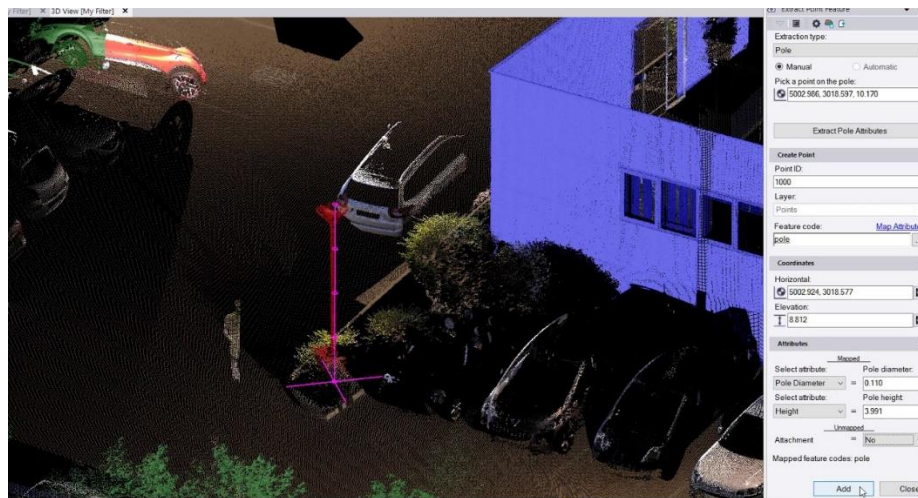
รูปที่ 2-39 ตัวอย่างข้อมูลแบบจุดพอยต์คลาวด์จากอุปกรณ์เลเซอร์วัดระยะแบบ 3D
