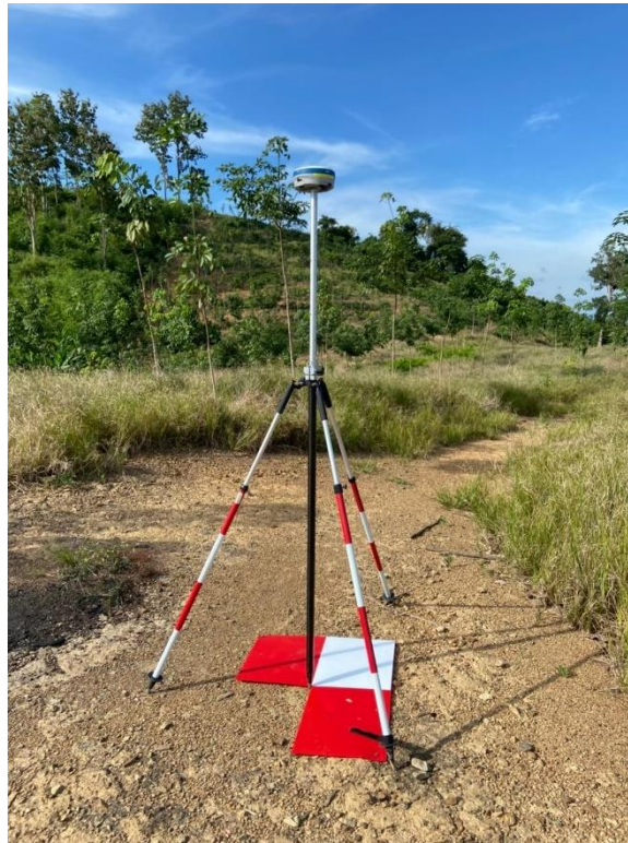
รูปที่ 4-7 การรังวัดค่าพิกัดจุดควบคุมภาพถ่ายด้วยเครื่องรับสัญญาณดาวเทียม GNSS
