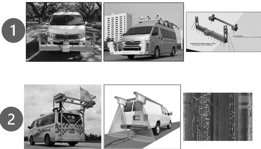
รูปที่ 1 รถสำรวจ พร้อมอุปกรณ์สำรวจสภาพทาง และกล้องถ่ายภาพ
