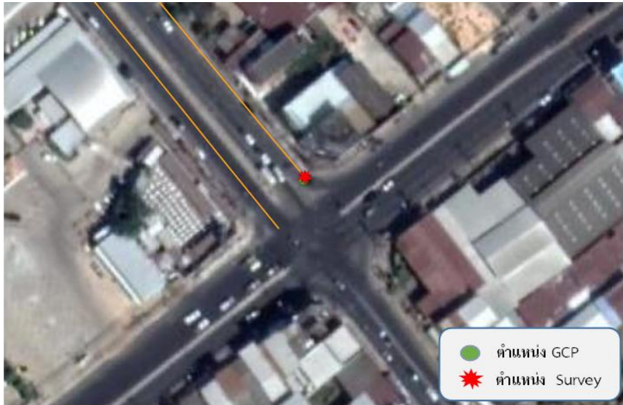
รูปที่ 4-96 แสดงตัวอย่างจุด GCP และจุดที่ทำการตรวจสอบ ตำแหน่งที่ 1
