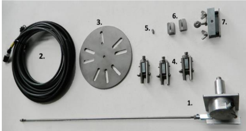
รูปที่ 4-23 รายละเอียดเครื่องวัดระยะทาง
