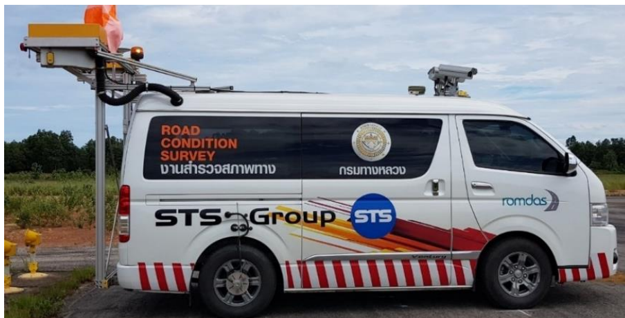
รูปที่ 4-122 รถสำรวจระบบ Laser Crack Measurement System
