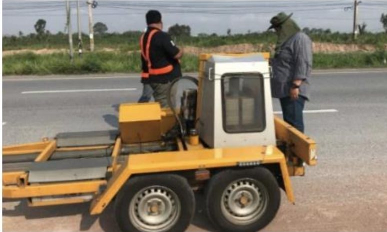
รูปที่ 4-167 ตัวอย่างชุดอุปกรณ์ทดสอบ FWD
