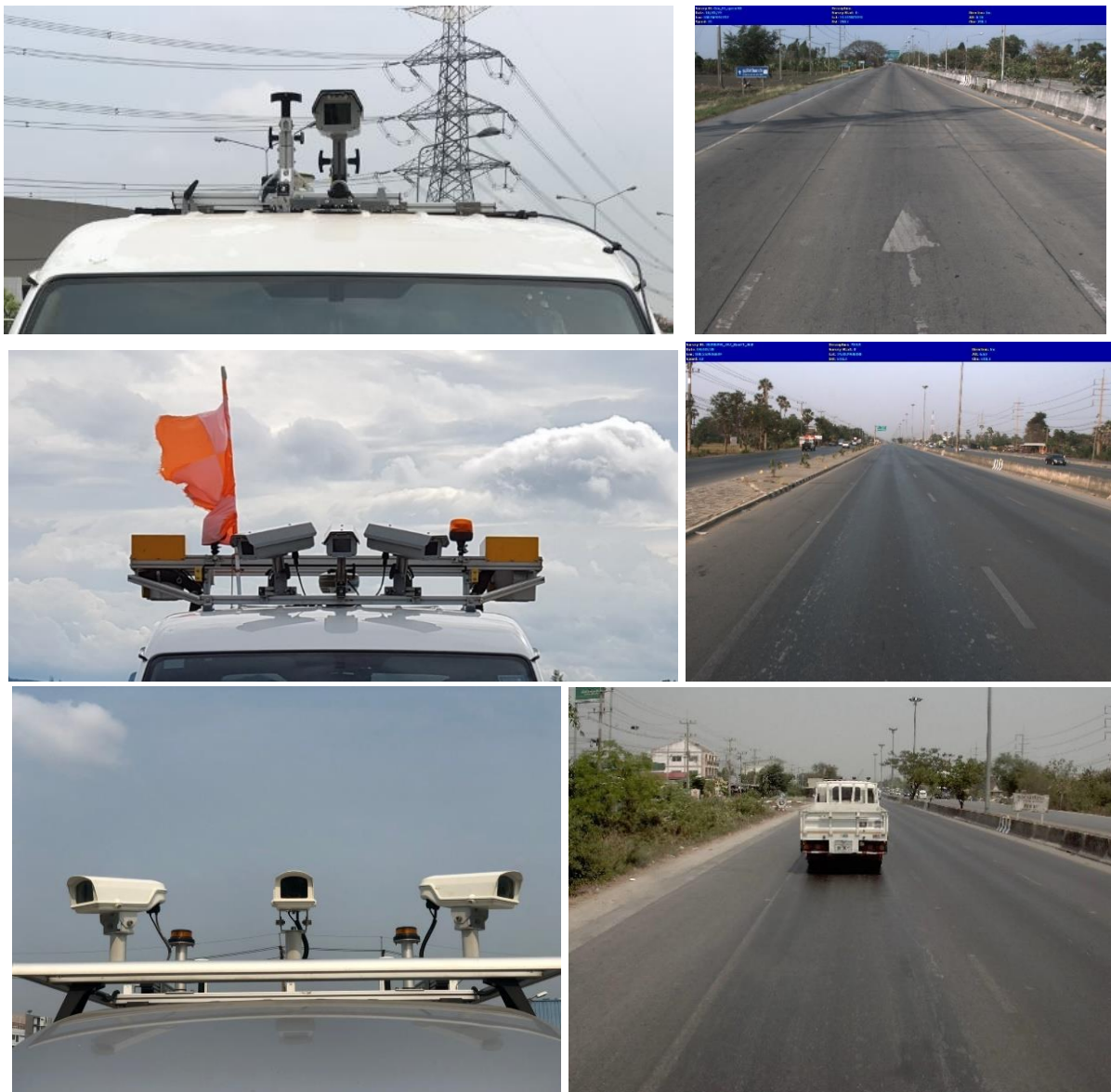
รูปที่ 4-21 ตัวอย่างภาพจากกล้องบันทึกภาพสภาพภายในเขตทาง
