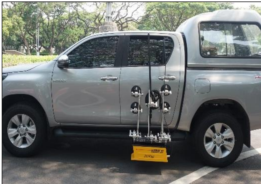
รูปที่ 4-154 ตัวอย่างการติดตั้งเครื่องมือ Pavement Marking Retro Reflectivity กับยานพาหนะ
