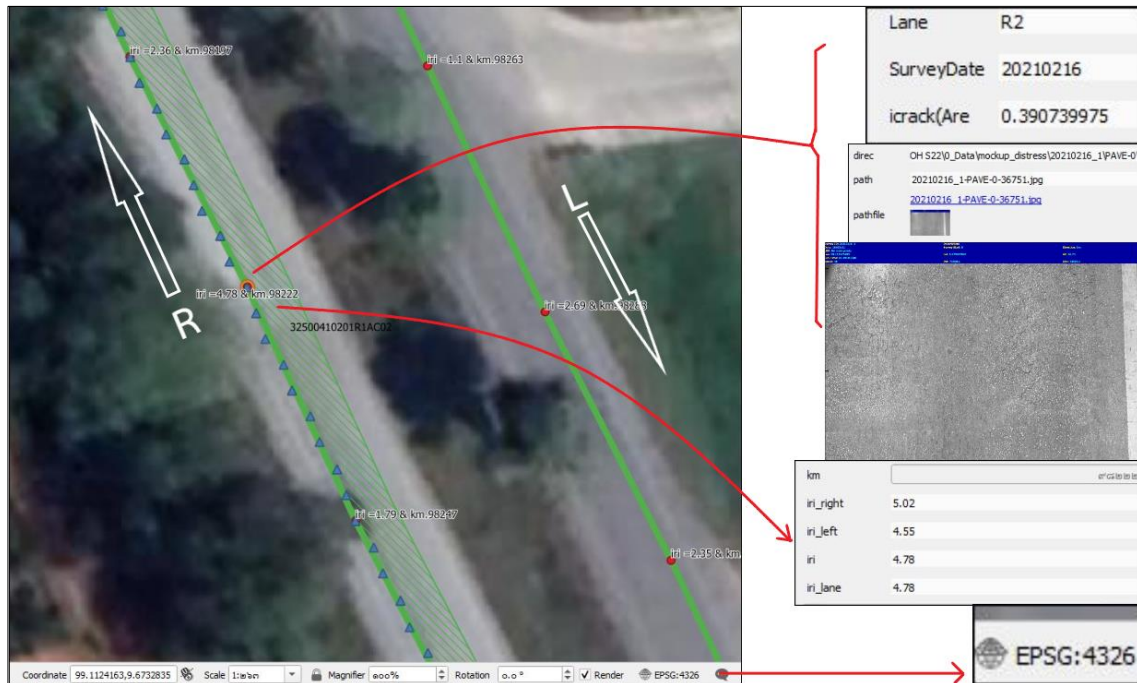
รูปที่ 4-113 แสดงจุดพิกัดค่าความเสียหายผิวทาง ค่าเฉลี่ยความขรุขระสากล (IRI) และภาพถ่ายความเสียหายผิวทางในรูปแบบแผนที่ (GIS)
