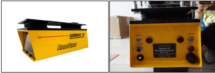
รูปที่ 4-153 อุปกรณ์ Road Stripe Assessment at Highway Speeds
