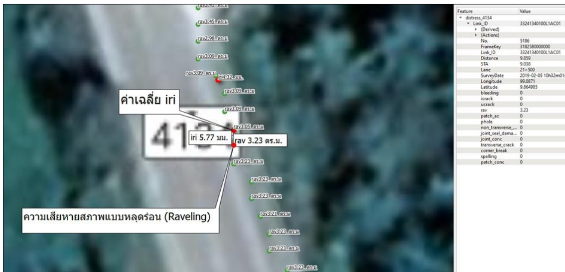
รูปที่ 4-86 แสดงการประมวลผลการสำรวจในรูปแบบแผนที่ (GIS) ข้อมูลที่เกิดความเสียหายสัมพันธ์กับค่าเฉลี่ย IRI ที่สูงตามข้อมูลประเมิน
