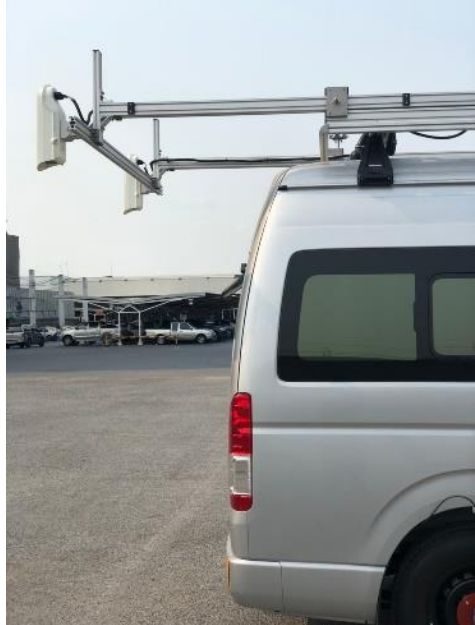
รูปที่ 4-20 กล้องบันทึกภาพผิวทาง และตัวอย่างภาพจากกล้องบันทึกภาพผิวทาง
