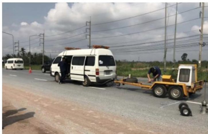
รูปที่ 4-166 ตัวอย่างรถตุ้ลากจูงและรถลากพ่วงทดสอบเครื่องมือ FWD
