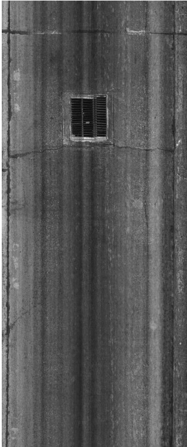
รูปที่ 4-67 แสดงภาพถ่ายผิวทางที่สร้างขึ้นจากเลเซอร์
