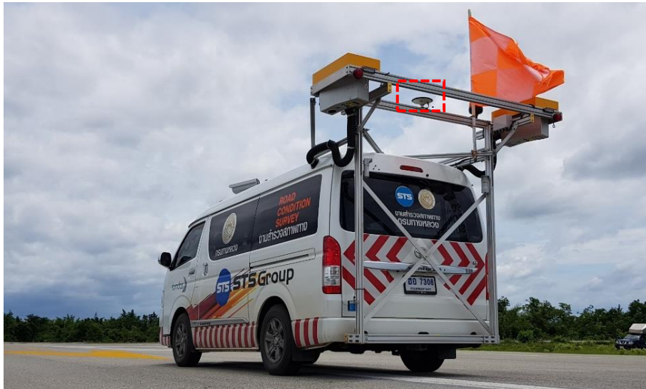
รูปที่ 4-124 อุปกรณ์รับค่าพิกัดตำแหน่งจากสัญญาณดาวเทียมแบบ GNSS
