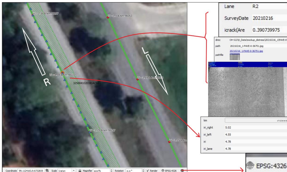
รูปที่ 3-123 แสดงจุดพิกัดค่าความเสียหายผิวทาง ค่าเฉลี่ยความขรุขระสากล (IRI) และภาพถ่ายความเสียหายผิวทางในรูปแบบแผนที่ (GIS)
