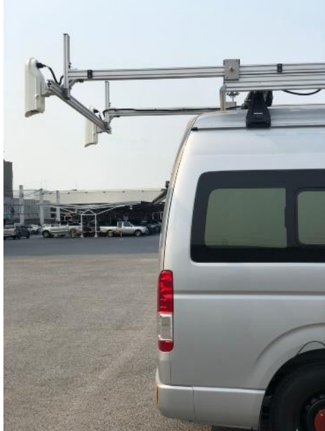
รูปที่ 3-20 กล้องบันทึกภาพผิวทาง และตัวอย่างภาพจากกล้องบันทึกภาพผิวทาง
