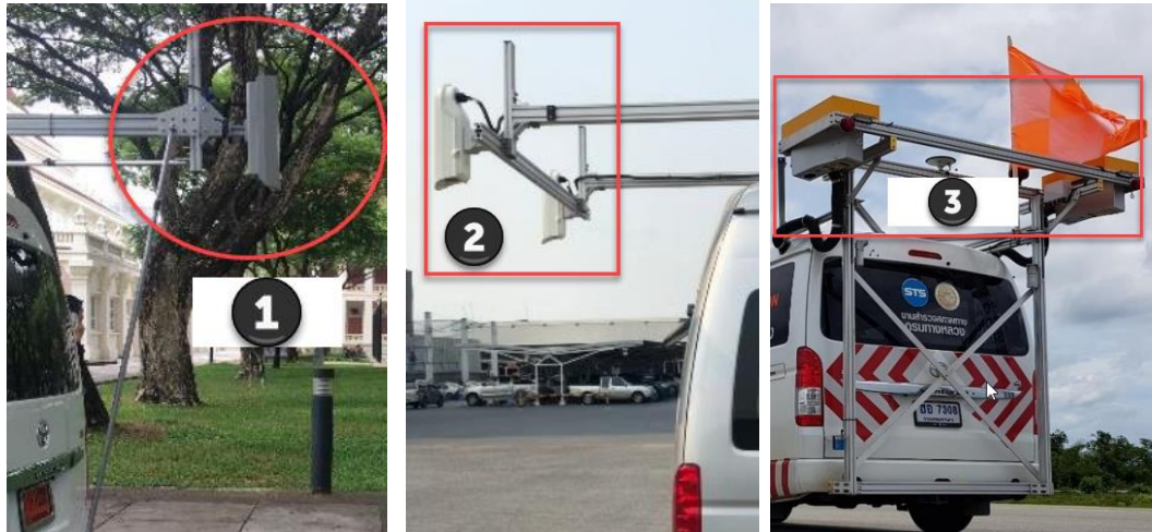
รูปที่ 2-22 ภาพแสดงตำแหน่งอุปกรณ์ที่ใช้ในการจัดเก็บภาพถ่ายผิวทางของรถสำรวจคันที่ 1 คันที่ 2 และคันที่ 3 ตามลำดับ
