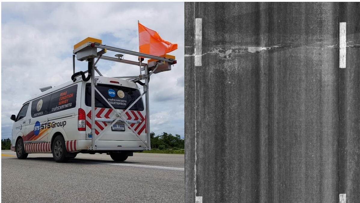
รูปที่ 3-19 อุปกรณ์ถ่ายภาพผิวทาง (LCMS) และตัวอย่างภาพจากอุปกรณ์ถ่ายภาพผิวทาง (LCMS)
