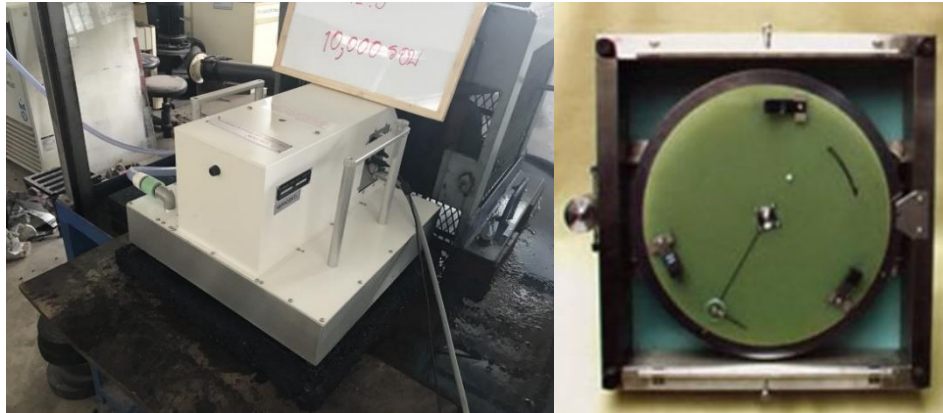
รูปที่ 2-50 เครื่องมือ Dynamic Friction Tester (DFT)
