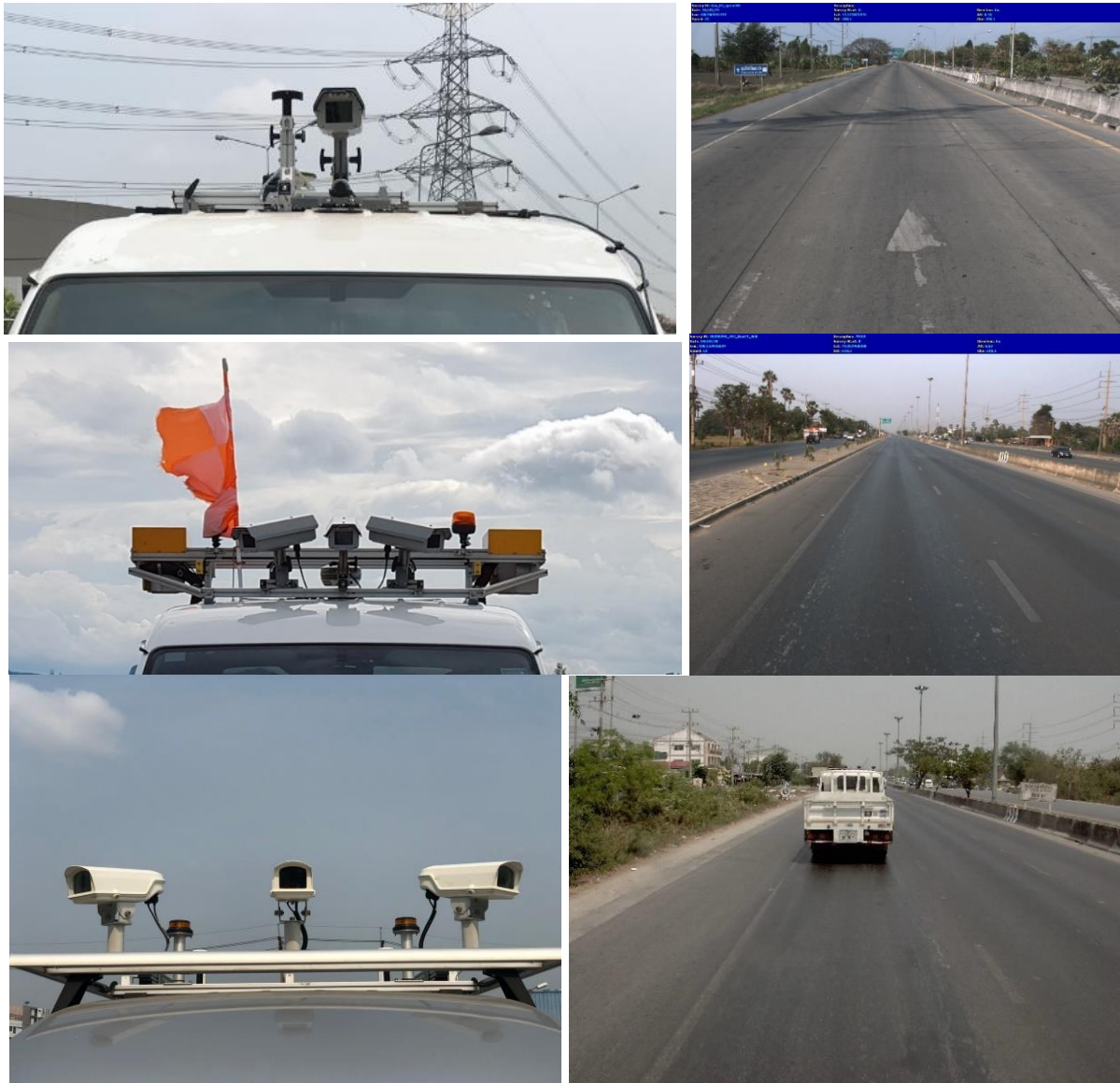
รูปที่ 3-21 ตัวอย่างภาพจากกล้องบันทึกภาพสภาพภายในเขตทาง
