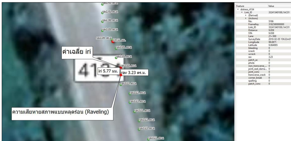
รูปที่ 3-95 แสดงการประมวลผลการสำรวจในรูปแบบแผนที่ (GIS) ข้อมูลที่เกิดความเสียหายสัมพันธ์กับค่าเฉลี่ย IRI ที่สูงตามข้อมูลประเมิน
