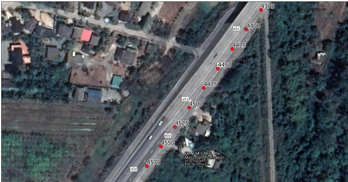
รูปที่ 3-92 การประมวลผลข้อมูลการสำรวจในรูปแบบของแผนที่ (GIS) โดยพิจารณาถึงระบบพิกัดอ้างอิงที่เป็นมาตรฐานและสามารถจัดเก็บในระบบฐานข้อมูล Roadnet ได้อย่างเหมาะสม
