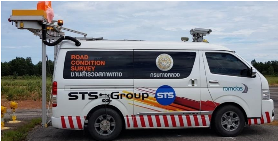
รูปที่ 2-2 รถสำรวจระบบ Laser Crack Measurement System
