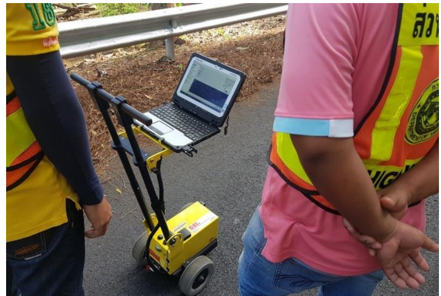
เครื่องมือวัดความเรียบของผิวทางชนิดรถเข็น (Walking Profiler)
