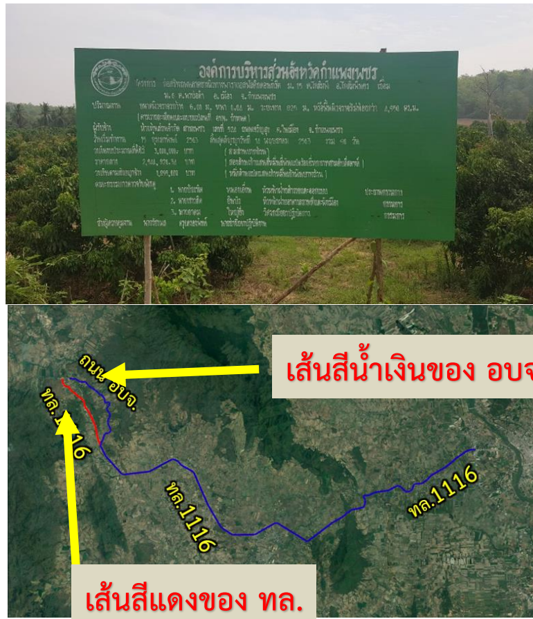
รูปที่ 2-3 ปัญหาสภาพทางไม่ตรงแผนสำรวจ กรณีสายทางสำรวจไม่ตรงตามแผนสำรวจ
