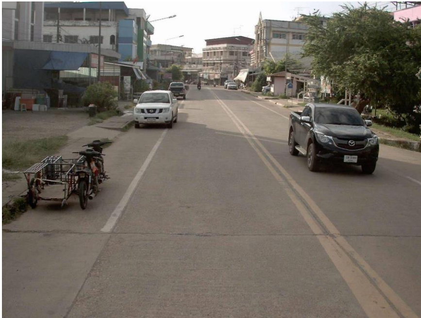
รูปที่ 2-2 ตัวอย่างปัญหาสภาพทางไม่ตรงแผนสำรวจ กรณีจำนวนช่องจราจรในระบบ Roadnet ระบุ 4 ช่องจราจร แต่สภาพพื้นที่เป็น 2 ช่องจราจร (แขวงทางหลวงนครพนม)
