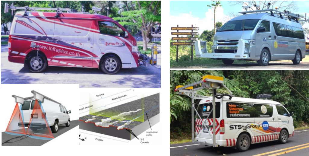
รูปที่ 1 รถสำรวจ พร้อมอุปกรณ์สำรวจสภาพทาง และกล้องถ่ายภาพ
