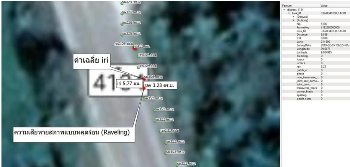
รูปที่ 1-43 แสดงข้อมูลที่เกิดความเสียหาย สัมพันธ์กับค่าเฉลี่ย iri ที่สูงตามข้อมูลประเมิน
