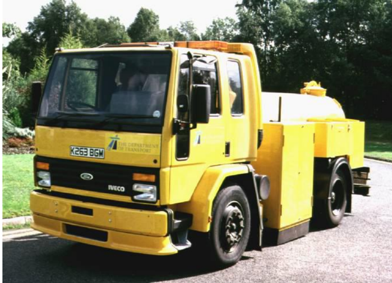
รูปที่ 1-117 SCRIM (Sideway-force Coefficient Routine Investigation Machine)
