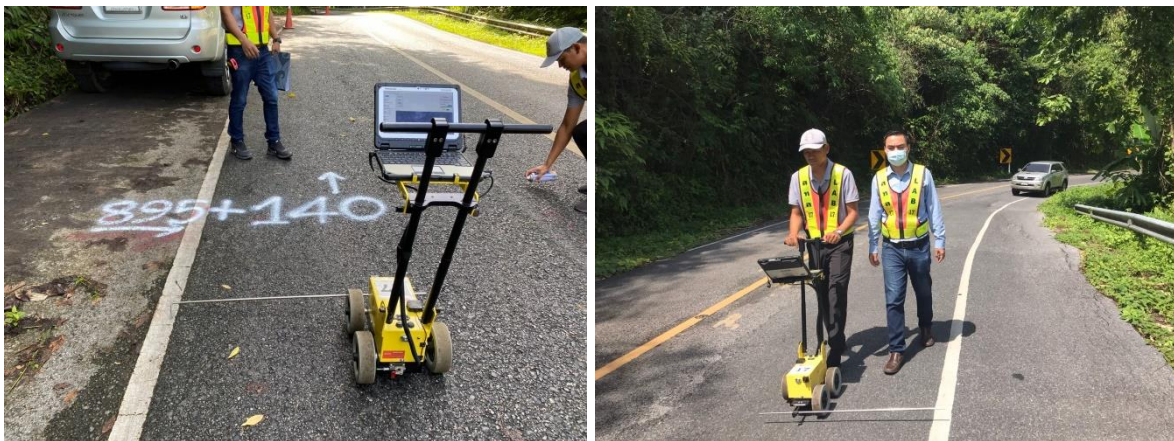
รูปที่ 1-140 เครื่องมือวัดความเรียบของผิวทางชนิดรถเข็น (Walking Profiler)
