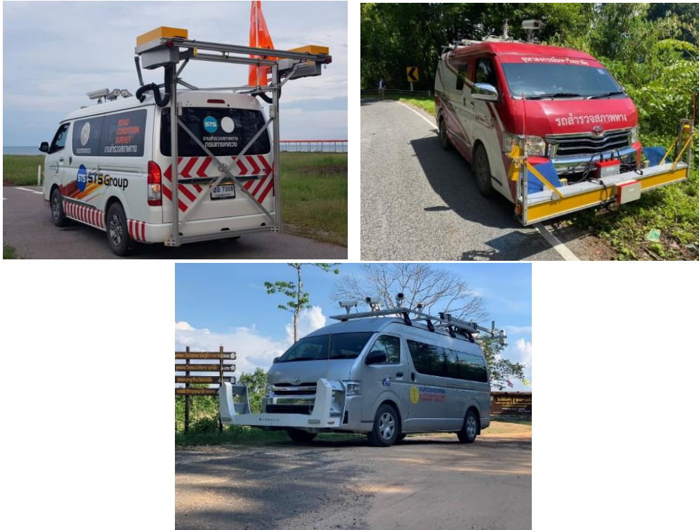
รูปที่ 1-139 เครื่องมือเลเซอร์ (Laser Profilometer)
