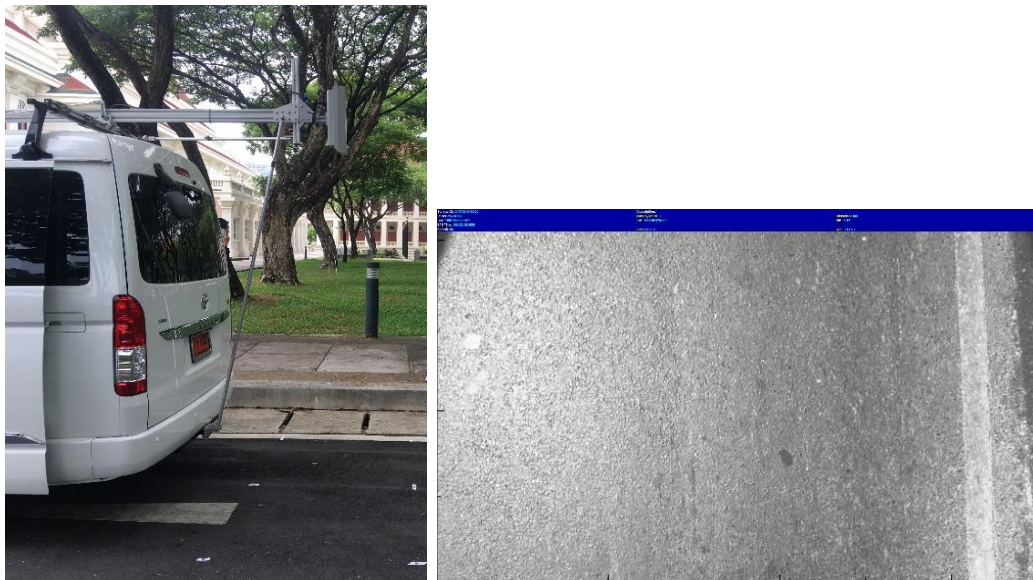
รูปที่ 1-4 กล้องบันทึกภาพผิวถนน และตัวอย่างภาพจากกล้องบันทึกภาพผิวทาง
