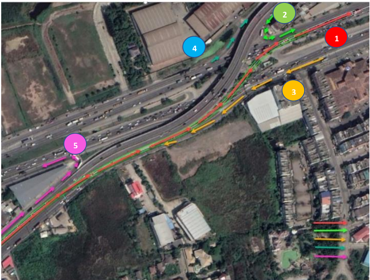
รูปที่ 1-164 ภาพมุมสูงการวิ่งจราจรทางแยกต่างระดับ (Interchange)
