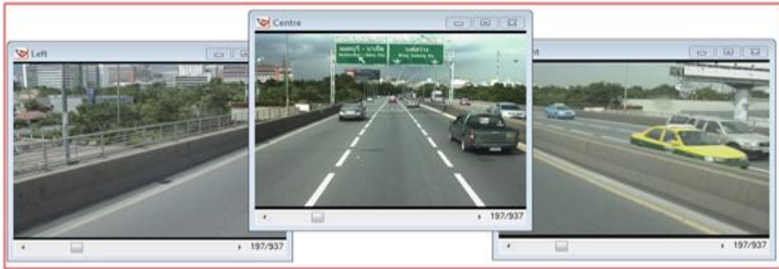
รูปที่ 2-13 ตัวอย่างภาพจากกล้องบันทึกภาพสภาพภายในเขตทาง
