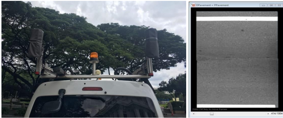
รูปที่ 2-10 ตัวอย่างการติดตั้งกล้องบันทึกภาพผิวทาง ในกรณีที่กล้องเดียวไม่สามารถบันทึกภาพได้ครอบคลุม 1 ช่องจราจร และตัวอย่างภาพจากกล้องบันทึกภาพผิวทาง
