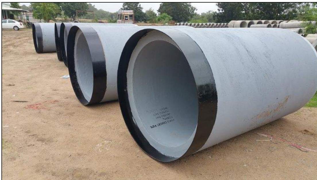
รูปที่ 6.2.1-7 ลักษณะท่อตัน (Jacking Pipe)
