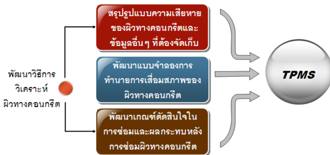
รูปที่ 4.4 ขั้นตอนการพัฒนาวิธีการวิเคราะห์สภาพสายทางคอนกรีตในระบบ TPMS
