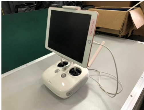
แสดงการประกอบอุปกรณ์ควบคุมระยะไกล (Remote Control) และอุปกรณ์แสดงผล
