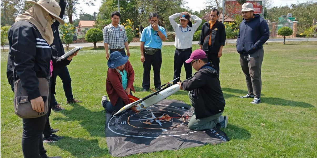
แสดงการตรวจสอบ Sensor Pitch, Roll ของอากาศยานฯ
