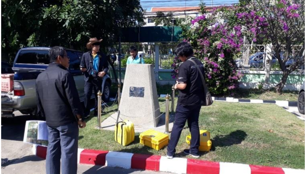
ภาพตัวอย่างการรับสัญญาณดาวเทียม GNSS ที่สำนักงานที่ดินในบริเวณที่จะปฏิบัติงาน
