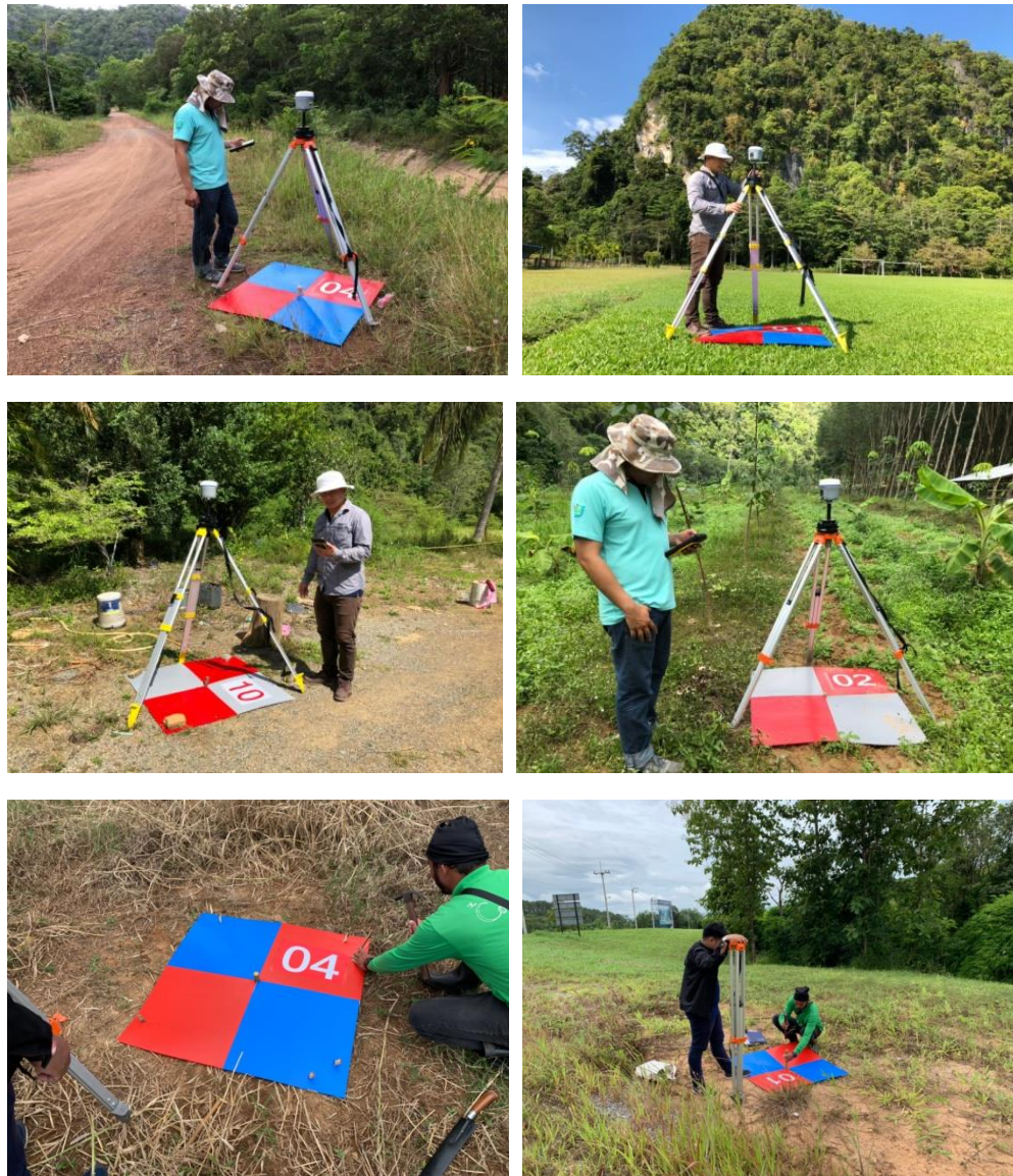
ภาพตัวอย่างการวางเป้าที่จะทำการจุดควบคุมภาคพื้นดิน Ground control point (GCP) และจุดตรวจสอบภาพ Check point (CP)
