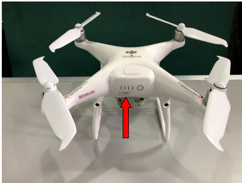
แสดงการติดตั้งแบตเตอรี่
