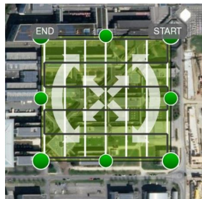
แสดงรูปแบบการบิน แบบ Double Grid
