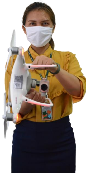
แสดงการจัดวางอากาศยานฯ เพื่อทำการคาร์ิบเทเข็มทิศ (Calibration the Compass) (๒)
