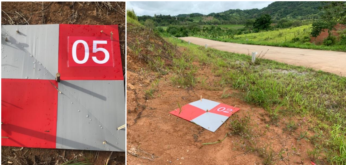
ภาพตัวอย่างจุดควบคุมภาคพื้นดิน Ground control point (GCP) ที่มีขนาดและสีที่เหมาะสมมีความคมชัดและ เห็นได้เด่นชัดในทุกภาพที่ปรากฏ
