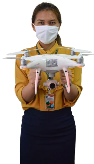
แสดงการจัดวางอากาศยานฯ เพื่อทำการปรับเข็มทิศ (Calibration the Compass) (๑)
