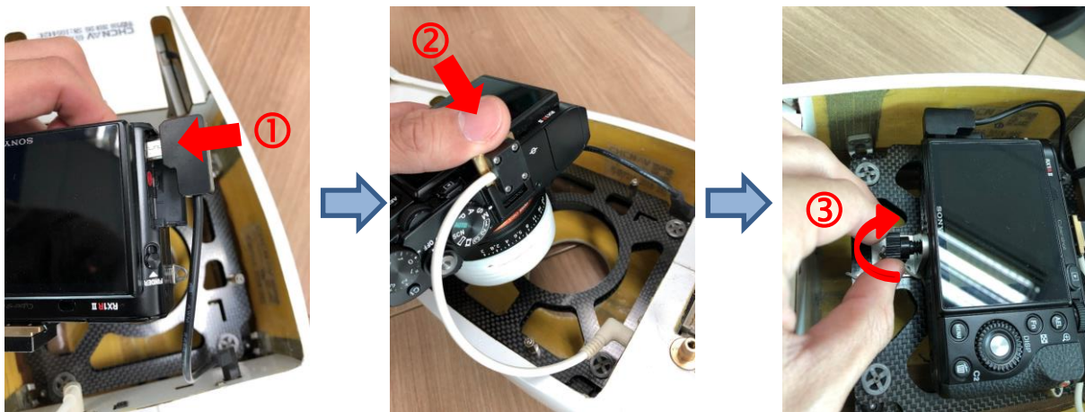
แสดงขั้นตอนการติดตั้งกล้องถ่ายภาพกับอากาศยานฯ
